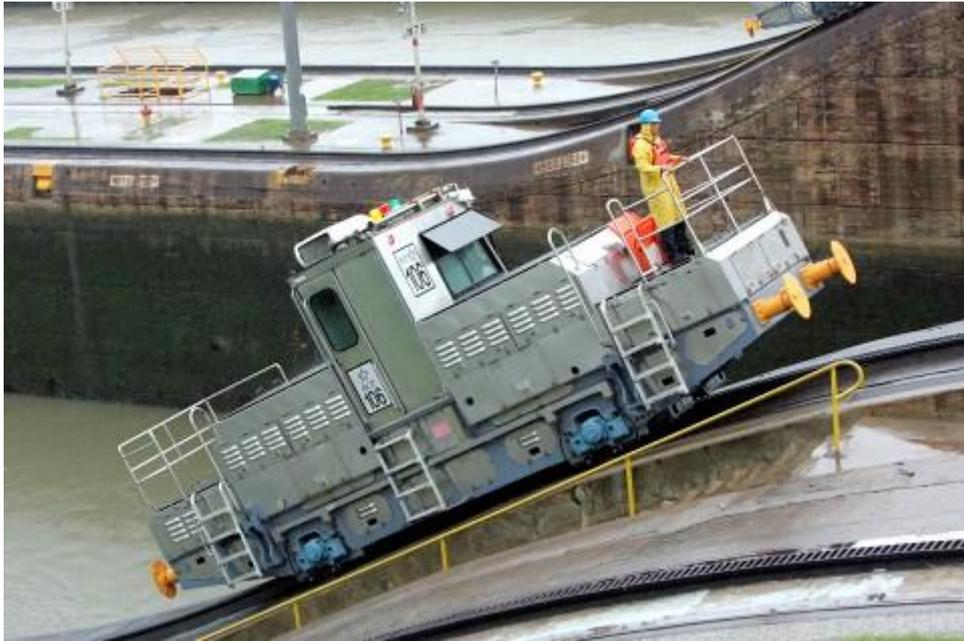
5. Locomotora 106 ascendiendo a otro nivel de esclusas.
