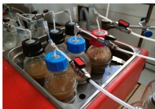
Figura 3.2.- Segundo Set de biodigestores
