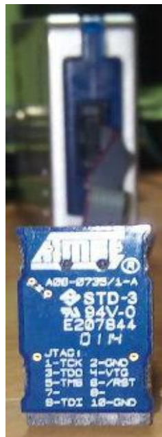
Figura 3.4: Adaptador JTAG para AVR
