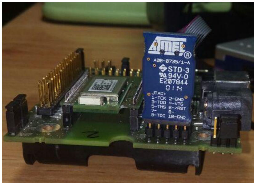
Figura 3.6: Resultado de conectar el dispositivo JTAGICE3 al puerto JTAG de la placa de manera correcta
