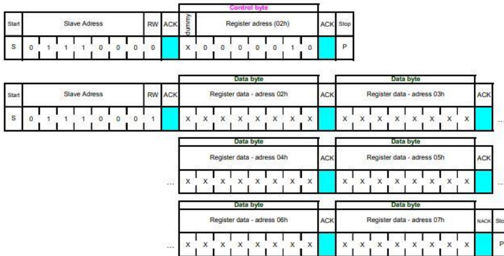
Figura 5.3: Obtención de los valores de los ejes del acelerómetro haciendo uso de la comunicación I 2 C [38]
