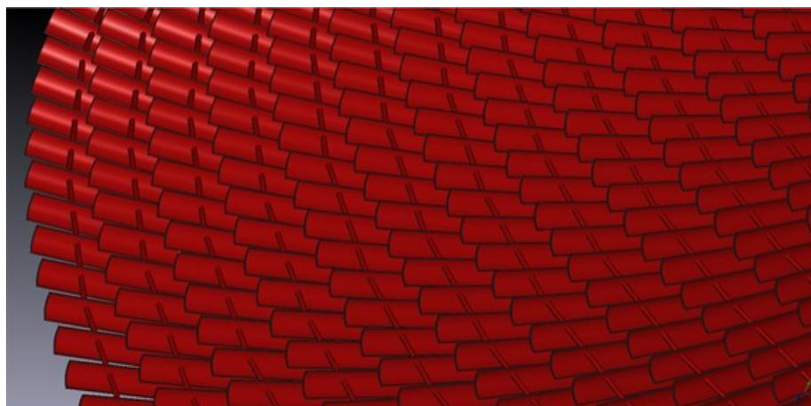
**Figura 4.16:** Detalle del zunchado de los álabes de la turbina
