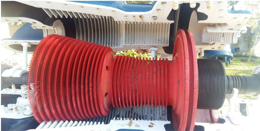
**Figura 4.3:** Foto de rotor y toberas de la turbina
