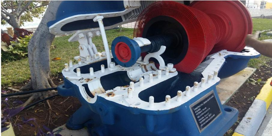
**Figura 4.7:** Carcasa de la turbina; parte inferior
