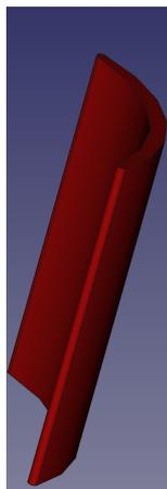
**Figura 3.14:** Extrusión de un álabe
