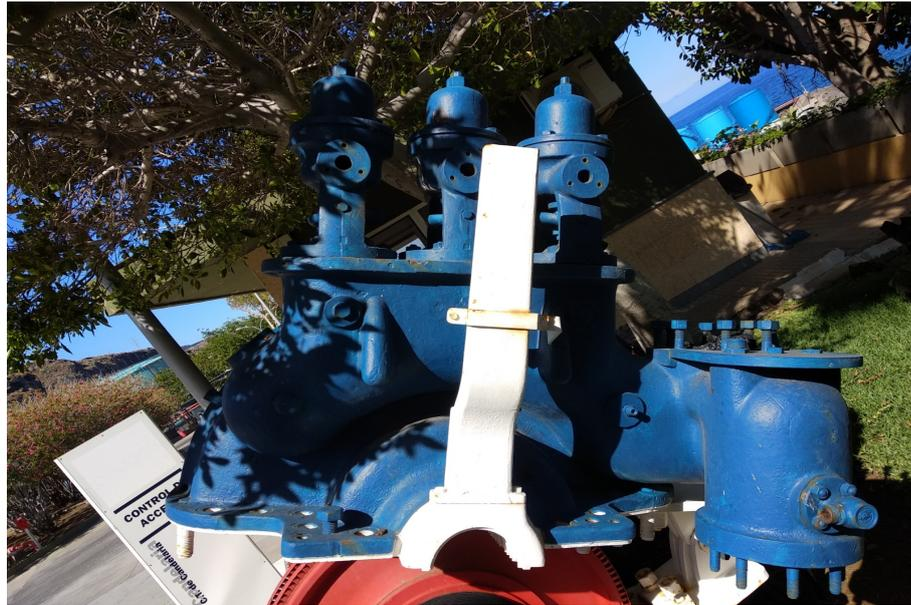
**Figura 4.19:** Válvula de regulación de la turbina
