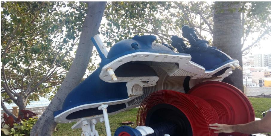
**Figura 4.8:** Carcasa de la turbina; parte superior
