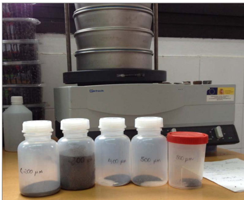
Figura 2.14. Arena negra volcánica caracterizada por tamaño después del tamizado.
