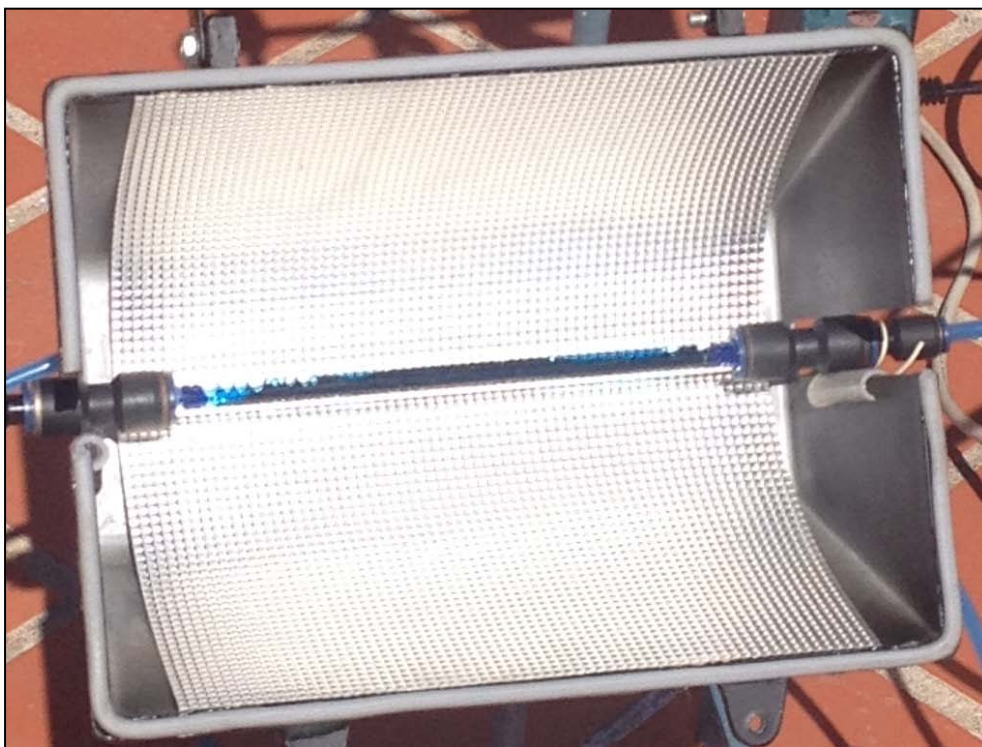
Figura 3.18. Reactor de lecho fijo rodeado del colector cilindro parabólico.
