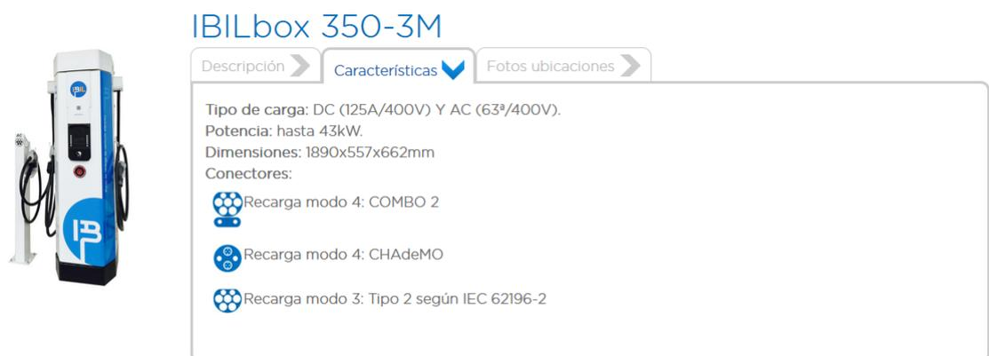
**Figura 8: Cargador CHAdeMO + COMBO + Tipo 2**
