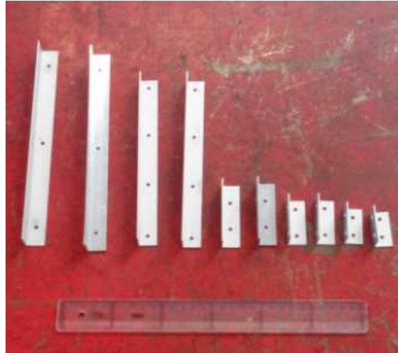
Figura 65. Perfiles de unión. Fuente: elaboración propia.
