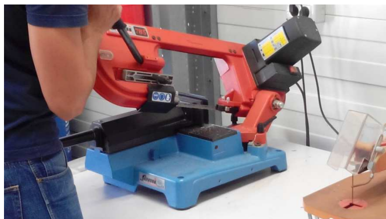
Figura 67. Corte del Perfil de unión. Fuente: elaboración propia.
