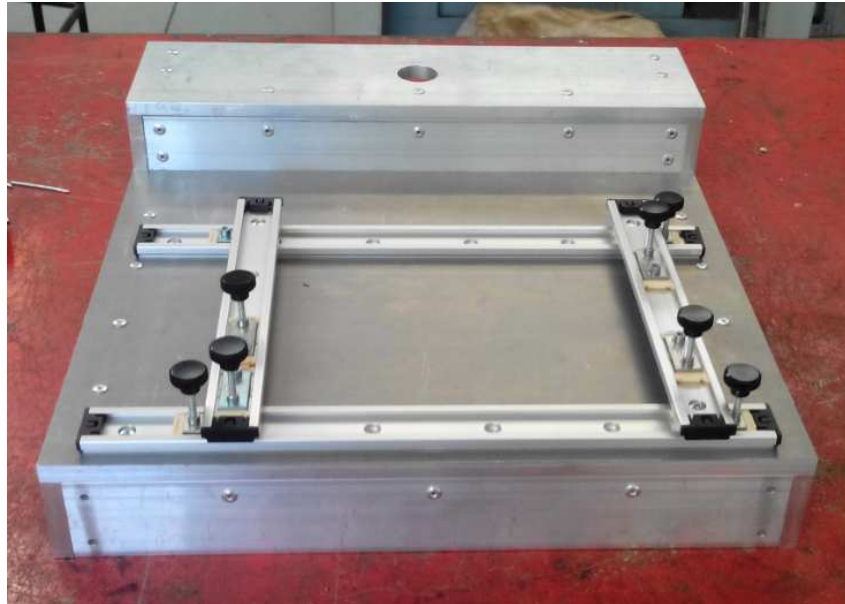
Figura 75. Conjunto de guías montadas en la Base. Fuente: elaboración propia.
