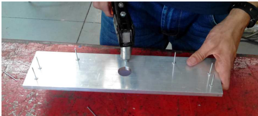
Figura 69. Remachado de los elementos. Fuente elaboración propia.
