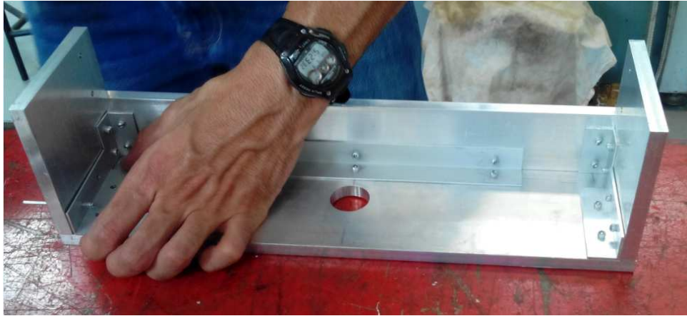
Figura 29. Montaje de una parte de la Base. Fuente: elaboración propia.
