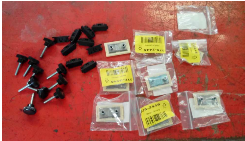
Figura 71. Mesas deslizantes, tapas de extremos del carril y Pomos. Fuente: elaboración propia.
