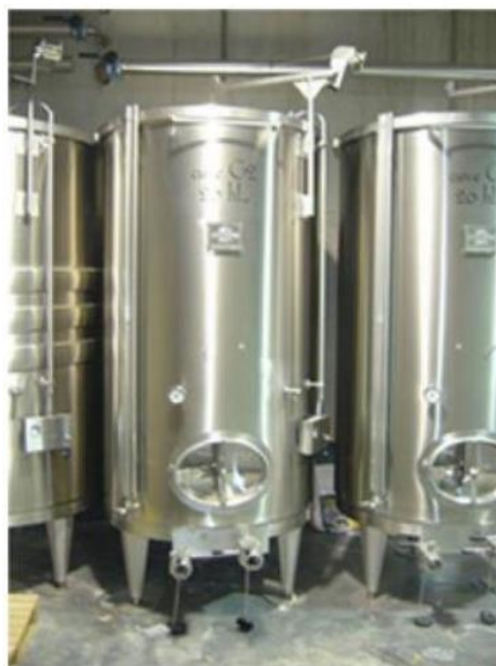
Ilustración 1: Cuba de Almacenamiento 2000 L de Acero Inox (10)
