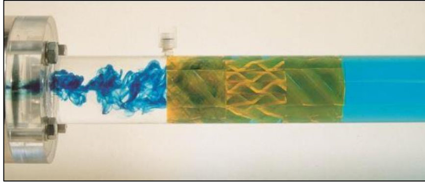
Ilustración 4: Turbulencia provocada por un Mezclador Estático (13)
