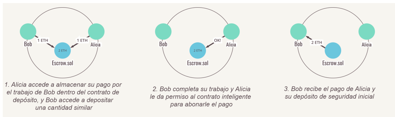
Figura 3.1: Ejemplo de funcionamiento de Smart Contract
