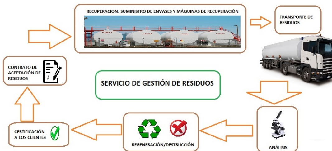
Figura 6.4: Esquema de recuperación de refrigerante residual
