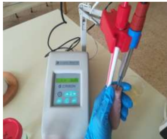
Foto 9 y 10. Calibrado y medida del pH en el músculo longissimus
