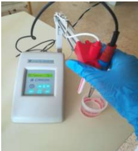
Foto 9 y 10. Calibrado y medida del pH en el músculo longissimus
