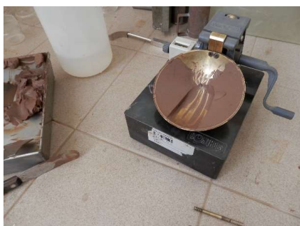
Figura II.22. Retirada de 10-15 g de muestra de los lados del surco donde se han unido las paredes.
