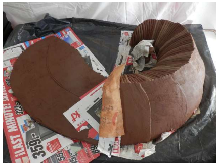
Figura IV.21. Protección con plástico de las partes de la pieza a ensamblar para que no se peguen.
