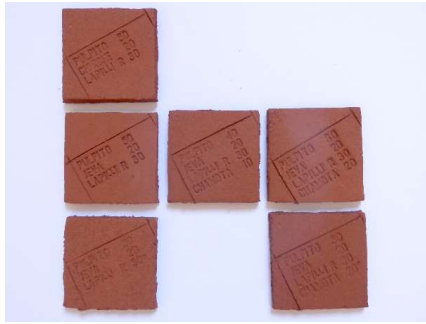
Figura III.38. Pastas elaboradas con barro de El Pulpito y Jeva con antiplásticos al 30, 40 y 50% horneadas en atmósfera oxidante.
