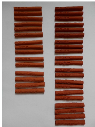
Figura III.41. Barras de deformación cocidas en atmósfera oxidante con pastas elaboradas con barro de Arguamul (izquierda) y barro de El Tanquillo (derecha).
