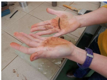
Figura II.24. Modelado de cilindros de 3 mm de grosor.
