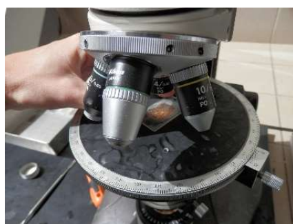
Figura II.33. Comprobación del grosor de las láminas delgadas en el microscopio petrográfico para la correcta identificación de los minerales.
