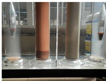
Figura II.9. Sedimentación de finos en el fondo de las probetas después de la lectura a las 48 horas.
