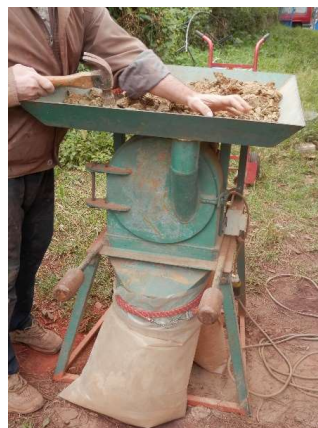
Figura III.5. Machacadora de tres martillos locos empleada para triturar tanto el masapés como los desgrasantes en El Alfár con José Ángel Hernández.
