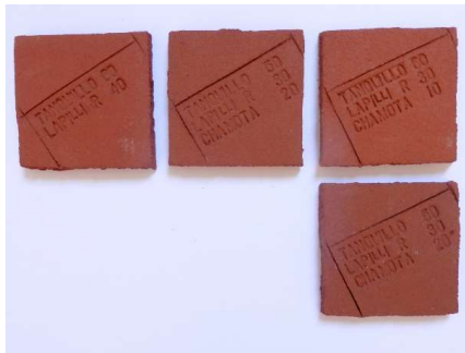
Figura III.29. Pastas elaboradas con barro de El Tanquillo y antiplásticos en porcentajes del 40 y 50% horneadas en atmósfera oxidante.
