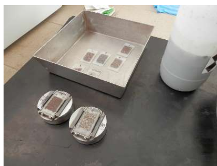
Figura II.31. Colocación de los portamuestras con las láminas delgadas sobre accesorio Borty para pulido final.
