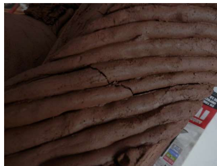
Figura IV.46. Grietas en la superficie elaborada con colombines.
