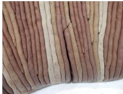
Figura IV.28. Grieta generada por las tensiones de la curva de la espiral producida durante el transporte al horno.
