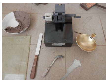
Figura II.20. De izquierda a derecha: espátula, acanalador A.S.T.M., acanalador de Casagrande y cuchara de Casagrande.
