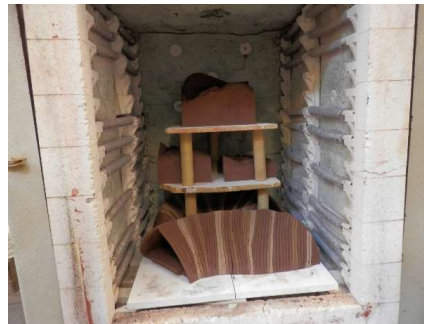
Figura IV.68. Horno mayor cargado con la pieza en espiral y la pieza múltiple.
