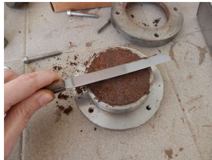
Figura II.13. Enrasado de la muestra en el anillo de acero.
