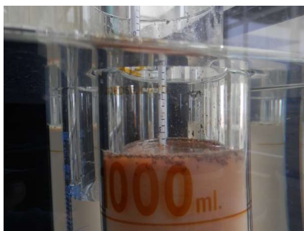
Figura II.8. Tomando la lectura del densímetro en la superficie de la muestra dentro de la probeta.
