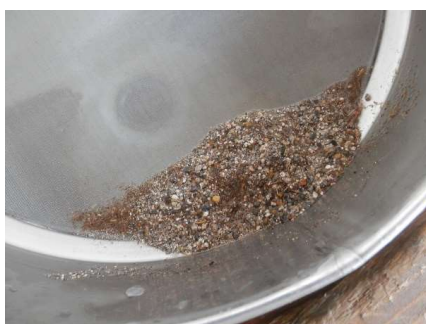
Figura II.10. Lavado de la muestra contenida en la probeta para retener los gruesos mayores de 0,080 mm.
