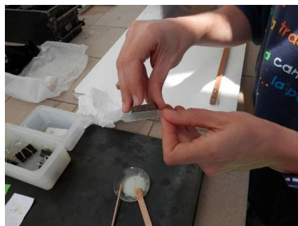
Figura II.29. Pegado de la cara pulida del prisma a portamuestras.
