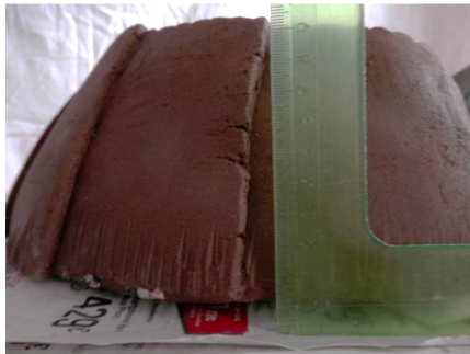
Figura IV.27. Alabeo de la placa base cuyo borde se ha levantado alrededor de 1 cm.
