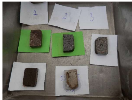
Figura II.27. Corte de los bloques en prismas de 3 x 2 x 0,8 cm aproximadamente.
