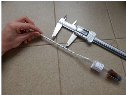
Figura II.6. Calibrado del densímetro.
