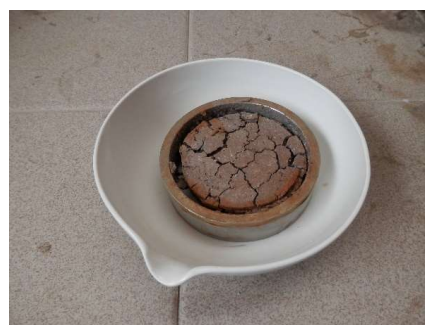
Figura II.17. Muestra agrietada en el interior del anillo después de ser desecada en la estufa.
