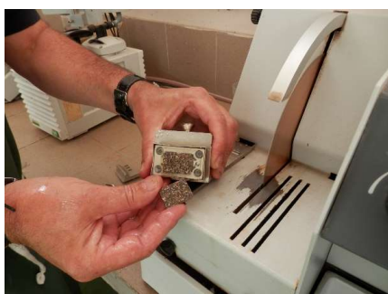
Figura II.30. Corte del prisma adherido al portamuestras para hacerlo más fino.
