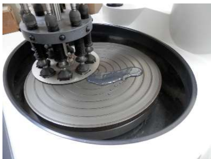
Figura II.28. Pulido de una de las dos caras del prisma con carburo de zinc 220 en proporción 80 g de polvo por un litro de glicerina.
