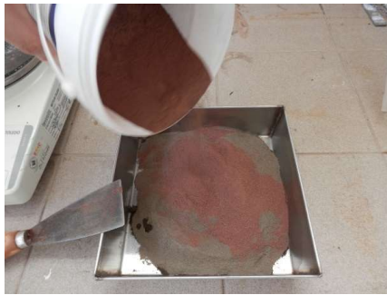
Figura III.8. Pesado del barro y el antiplástico para elaborar una pasta de 150 g.
