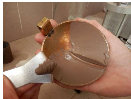
Figura II.21. Realización de surco en la muestra aplicada en el interior de la Cuchara de Casagrande.
