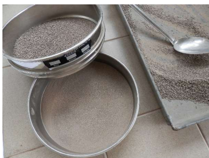
Figura II.18. Tamizado de la muestra por el tamiz UNE 0,40.
