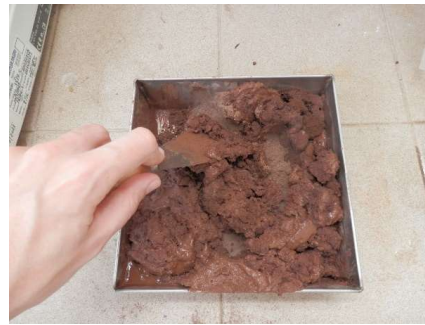
Figura III.9. Mezclado con espátula del barro y el antiplástico.
