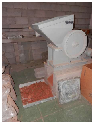
Figura III.4. Rotura inicial de las tejas para su posterior triturado en el Servicio de Laboratorios y Calidad de la Construcción del Gobierno de Canarias.
