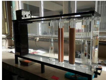
Figura II.7. Baño termostático con dos muestras.
