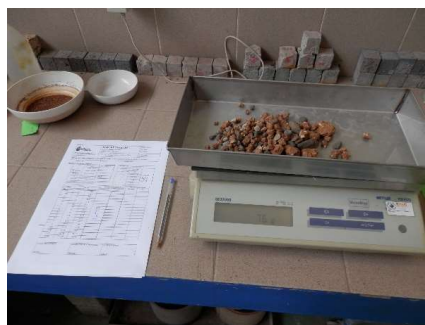
Figura II.5. Pesado de los gruesos retenidos en cada uno de los tamices UNE 63 / 50 / 40 / 25 / 20 / 12,5 / 10 / 6,3 / 5 / 2.
