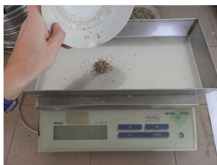
Figura II.11. Pesado de la arena retenida en cada uno de los tamices UNE 1,25 / 0,40 / 0,16 / 0,080.
