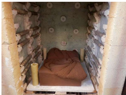
Figura IV.69. Piezas y pilares en la base del horno mediano.
