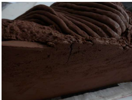
Figura IV.45. Grietas en las paredes de la caja.
