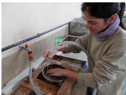
Figura II.4. Lavado de la muestra con disolución de hexametafosfato sódico para retener los gruesos mayores de 2 mm.
