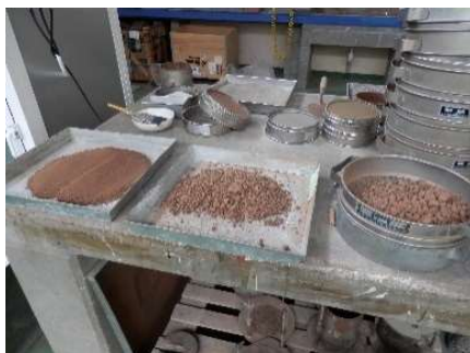
Figura II.2. Separación de finos y gruesos mediante tamiz UNE 2 mm.
