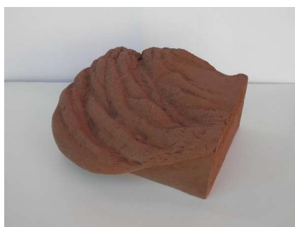
Figura IV.66. Prueba por apretón con barro de El Tanquillo sobrepasando los límites de la caja.
