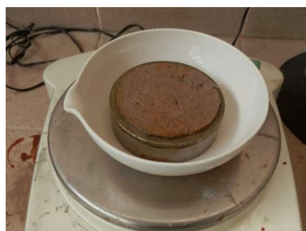
Figura II.16. Muestra en el interior del anillo hinchada tras la absorción de agua durante varios días.
