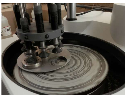
Figura II.32. Pulido final de las láminas delgadas con 90 g de carburo de zinc 1000 y 1/3 litro de glicerina y completado a un litro con agua destilada.
