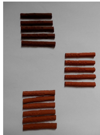
Figura III.42. Barras de deformación cocidas en atmósfera oxidante con pastas elaboradas con barro de Puntallana (arriba) y barro de Riquiáñez (centro) y barro de El Pulpito (abajo).
