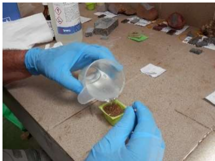
Figura II.26. Elaboración de pequeño bloque con la arena y resina.
