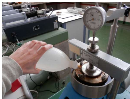
Figura II.15. Inundado de la muestra tras colocar otro disco poroso sobre el anillo y fijar el medidor.
