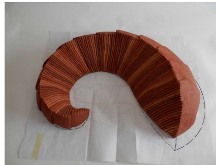
Figura IV.73. Contracción de la pieza en espiral cocida comparada con la plantilla de la base.
