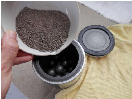
Figura II.34. Introduciendo muestra que pasa por el tamiz UNE 2 mm en el molinillo de bolas.
