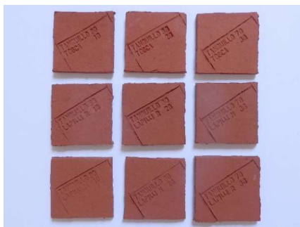
Figura III.20. Pastas elaboradas con barro de El Tanquillo y antiplásticos en porcentajes del 10, 20 y 30% horneadas en atmósfera oxidante.
