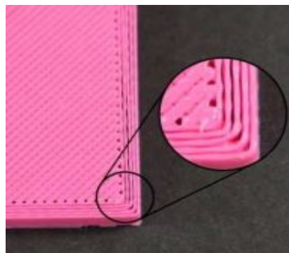
Figura 10.9 Fallo de impresión por poco plástico
