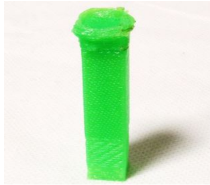
Figura 10.10 Fallo de impresión por mucho plástico
