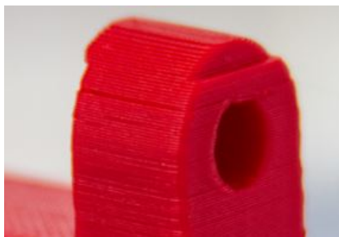
Figura 10.15 Fallo de impresión por desplazamiento de capas
