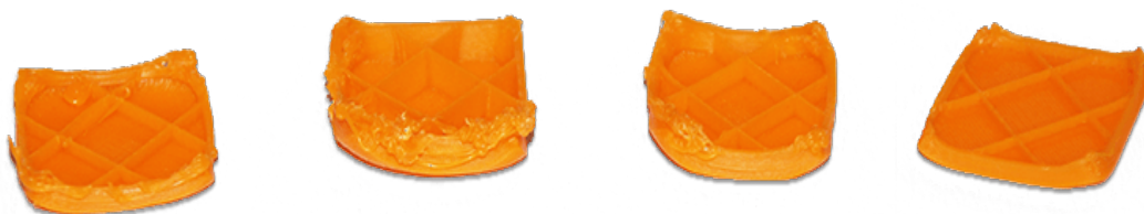
Figura 10.14 Fallo de impresión, Warping
