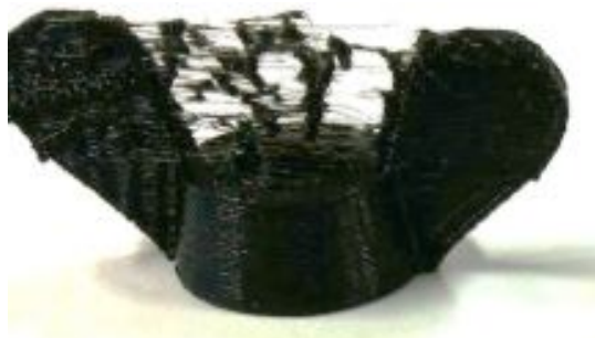
Figura 10.12 Fallo de impresión por hilos
