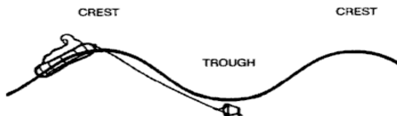
Figura 192. Despliegue de ancla flotante (Lifeboat Survival Manual, Desconocido)
