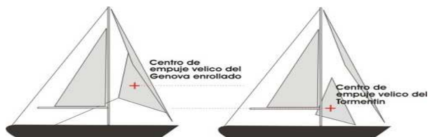
Figura 332. Centros de empuje de Génova enrollada y de Tormentín siendo más eficaz este último por su resistencia produciendo la Génova más escora < http://www.fondear.org/ >
