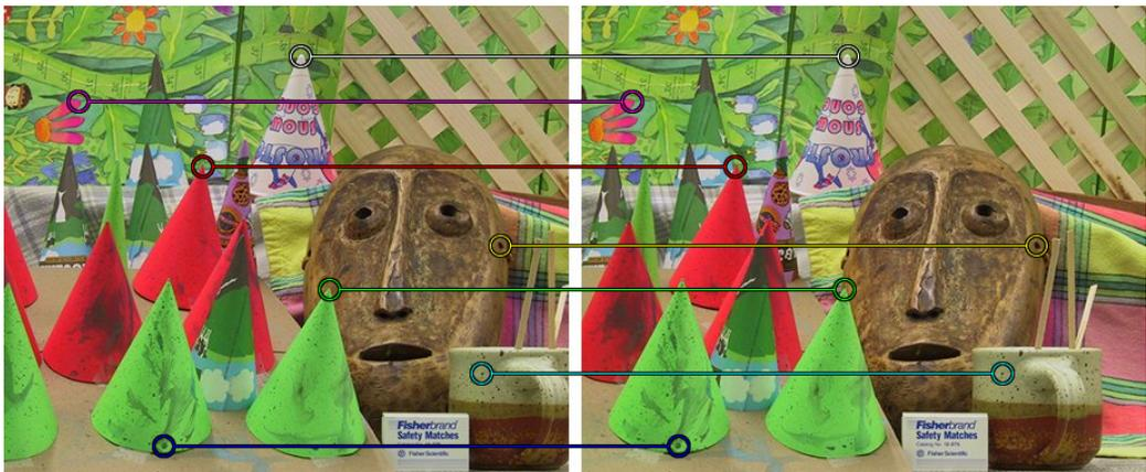
**Figura 1.4.** Demostración de la restricción epipolar.
