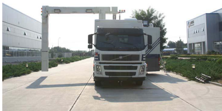
Foto n.º24. Escáner de contenedores con brazo desplegado ( 2 ).FUENTE: AEAT. Departamento de Aduanas e IIEE.
