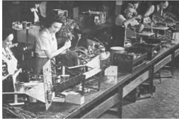
Foto n° . 37.Línea de montaje de radares SCR-270B en EEUU. FUENTE: www.exordio.com/1939-1945/civilis/telecom/radar3.html
