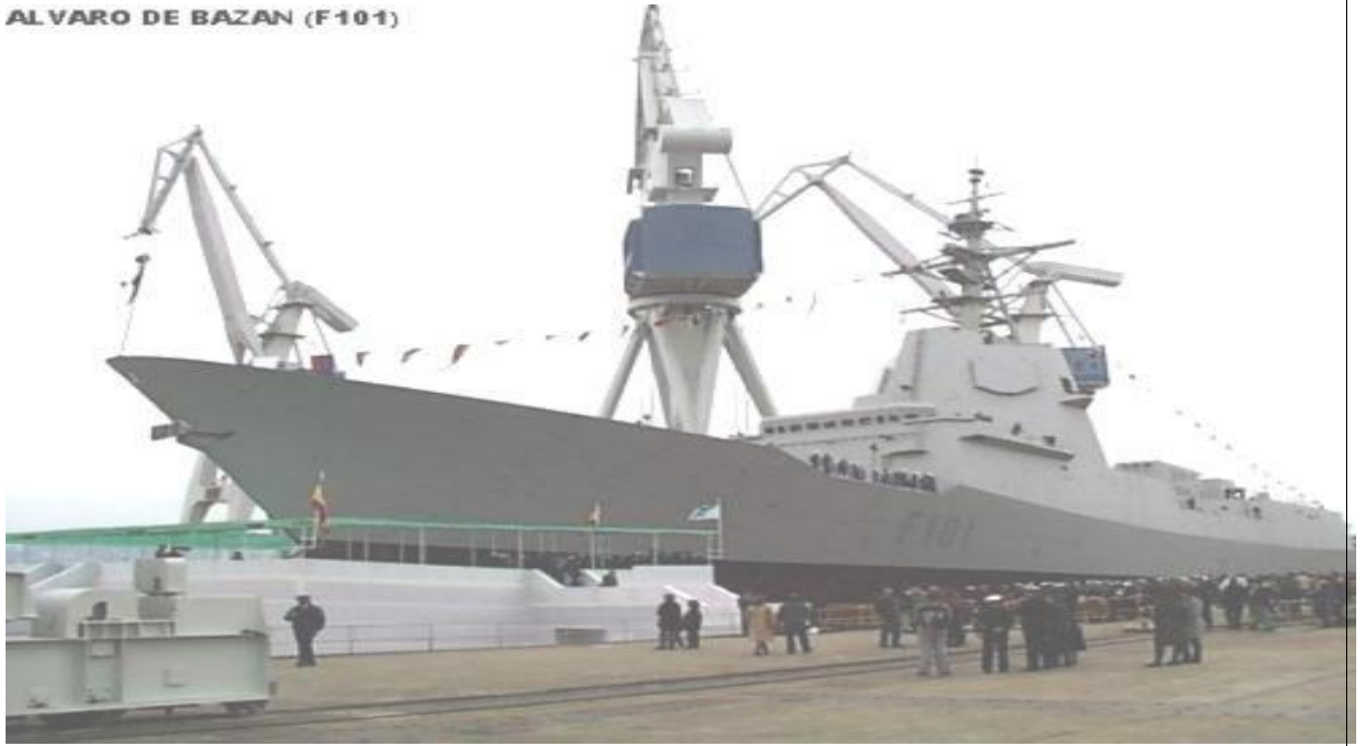
Foto nº. 52 . Obsérvese las antenas del radar integradas en la superestructura.
