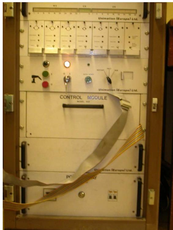
Figura 3-3: Controlador *Mark II* del robot PUMA-560. En el modulo de control se incluye la nueva *interface* entre el manipulador y un PC, mediante una tarjeta de adquisición Q8.
