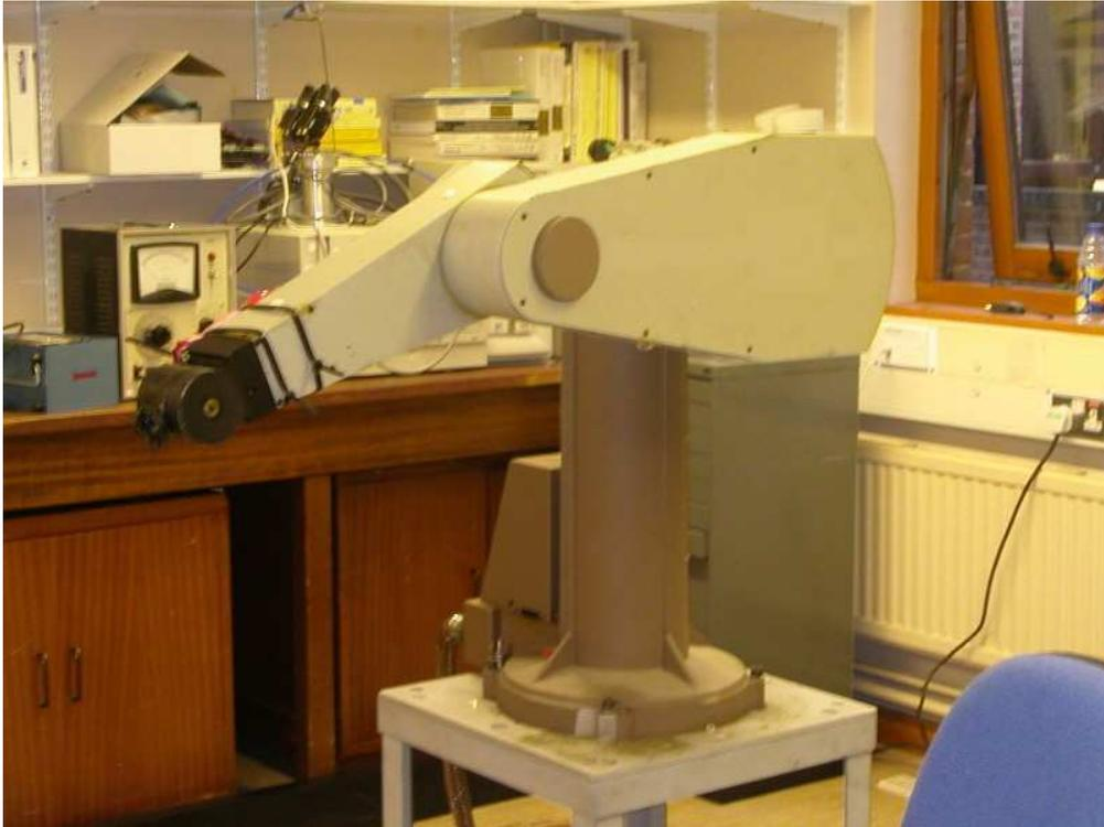
Figura 3-2: Robot manipulador PUMA-560 empleado en las distintas pruebas<sup>1</sup>.
