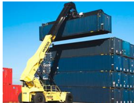
Ilustración 7: Grúa apiladora de contenedores
