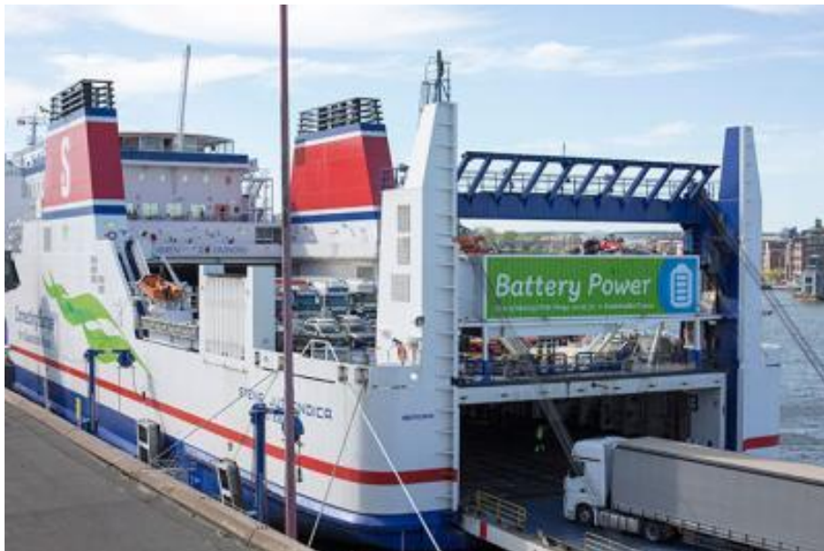
Figura 5.1 Baterías eléctricas como medio de propulsión híbrido.
