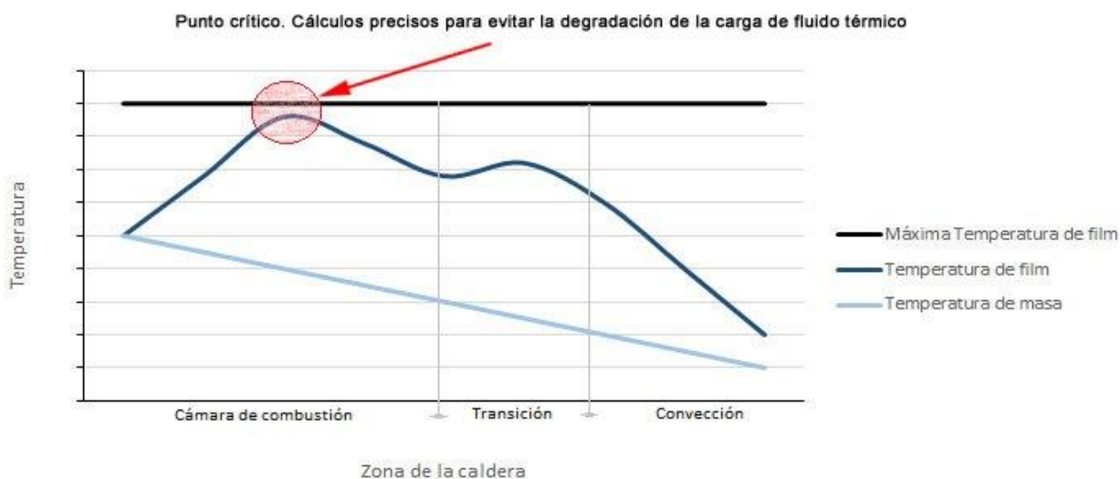
Gráfico 1. Transferencia de calor en el hogar. Fuente [9]
