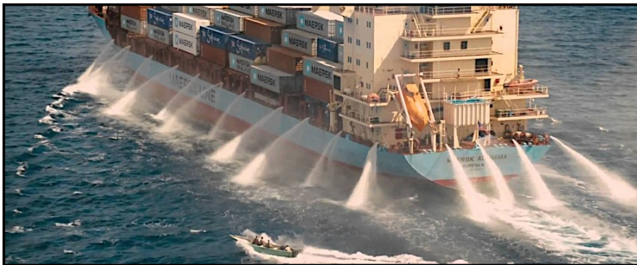
Ilustración 5.11 Mangueras contra incendio como medida antipiratas. [34]
