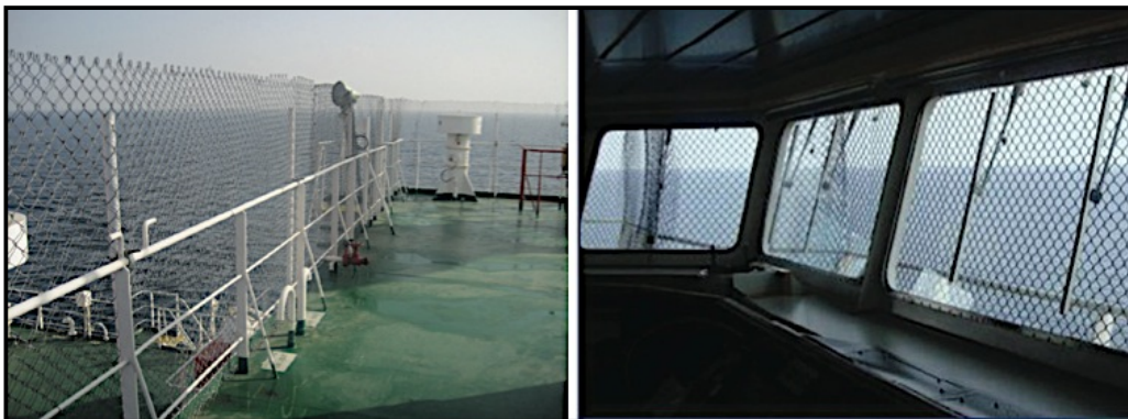
Ilustración 5.5 Medidas de protección para el puente. [13]
