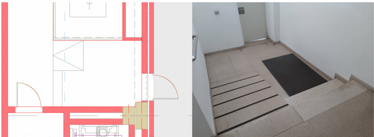
Figura 86. Relación de la planta con la rampa. Incoherencia de los planos.
