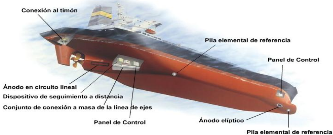
Figura nº 18. Esquema de Protección catódicas.
