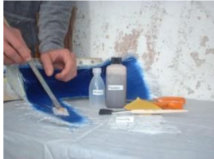
Figura nº 34. Aplicación de fibra.
