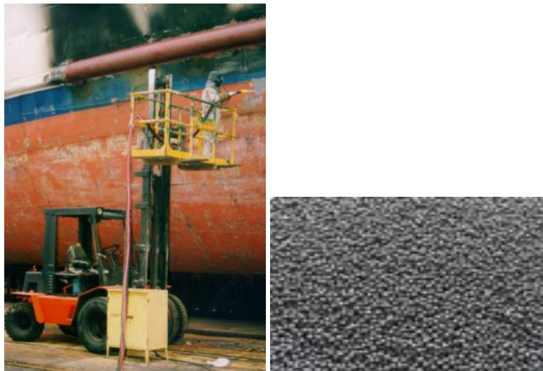
Figura nº 43. Limpieza de casco y detalle granalla.
