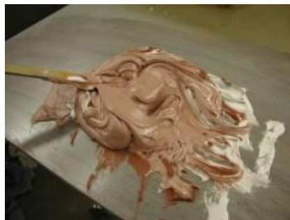
Figura nº 33. Mezcla de Epoxi.
