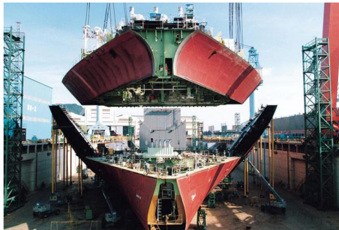
Figura nº 42. Construcción de buque por secciones.
