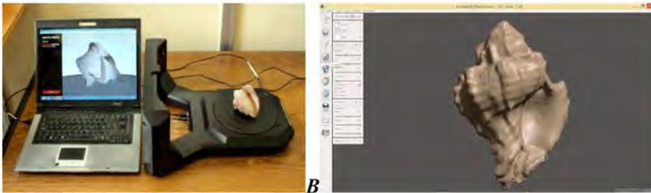
Fig. 3. Proceso de creación del modelo 3d de un fósil. A Makerbot Digitizier donde se observa el plato giratorio con el fósil de *Persististrombus latus*, y la figura en proceso de escaneado de forma automática. B. Edición en el programa gratuito Meshmixer del modelo 3D del fósil *Hexaples trunculus* escaneado.
