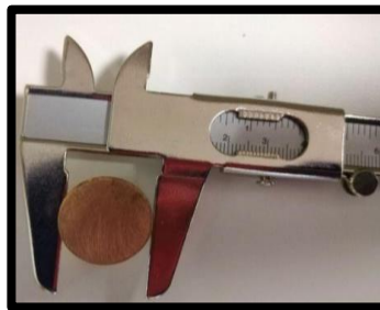
Figura 17: Medición del diámetro exterior de una probeta de latón seleccionada. Fuente: Propia.
