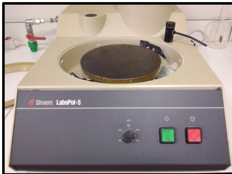
Figura 5: Pulidora modelo LABOPOL, marca Struers. Fuente: Propia.
