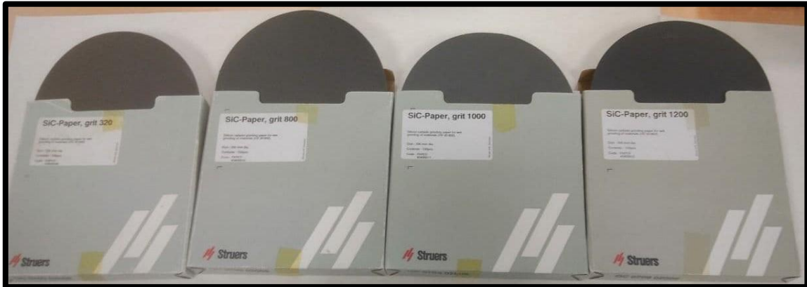
Figura 4: Papel de esmerilado circular para utilizar con las pulidoras, marca Struers. Fuente: Propia.
