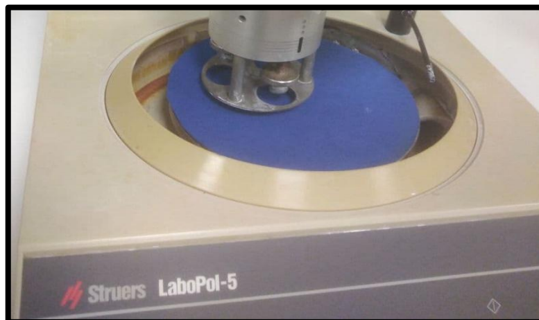
Figura 7: Pulidora LABOPOL-5 con un disco laminar y el disco de fieltro azul en el plato pulidor. Fuente: Propia.
