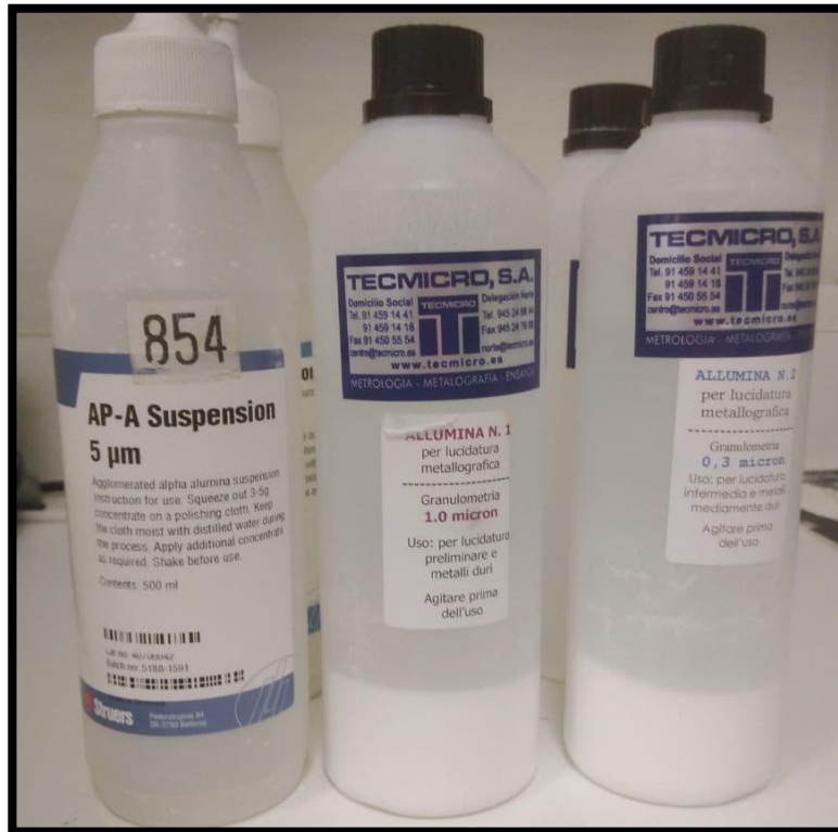
Figura 8: Recipientes de suspensión de alúmina de diferentes tamaños de grano De izquierda a derecha: 5 µm, 1 µm y 0,3 µm. Fuente: Propia
