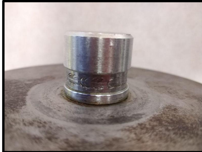
Figura 35: Modelo inicial propuesto para la sujeción del plato portamuestras. Fuente: Propia.
