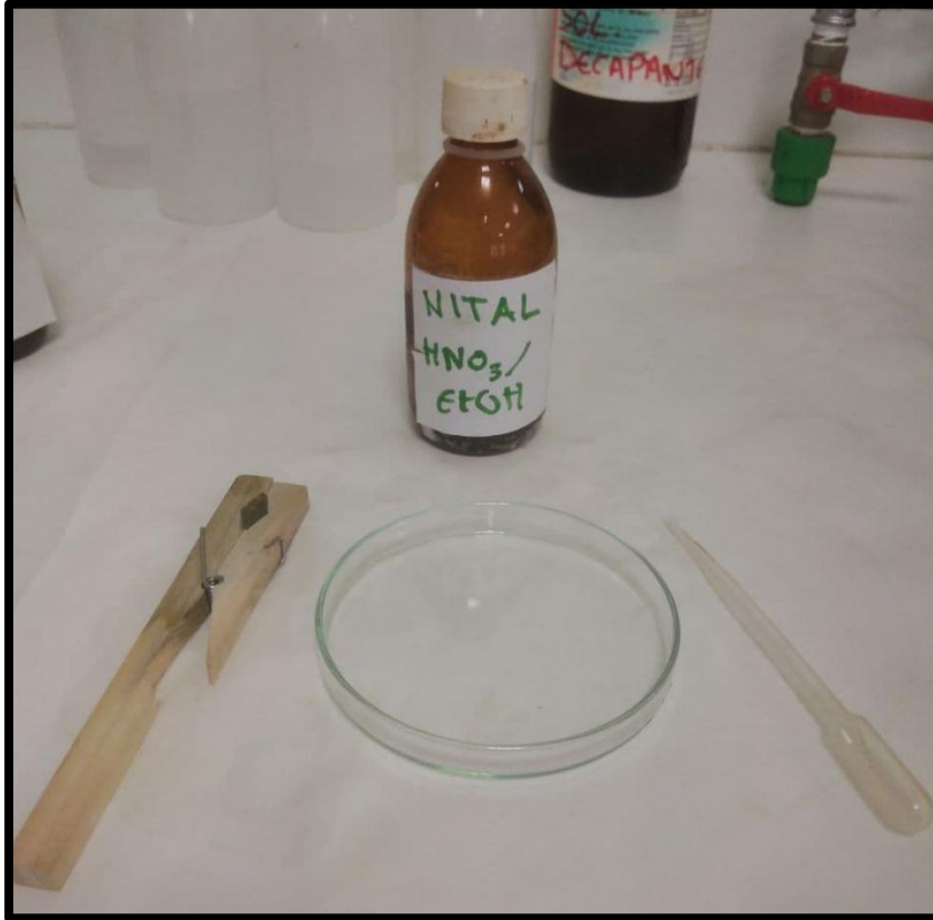
Figura 10: Ejemplo de preparación para un ataque químico con Nital. Fuente: Propia.
