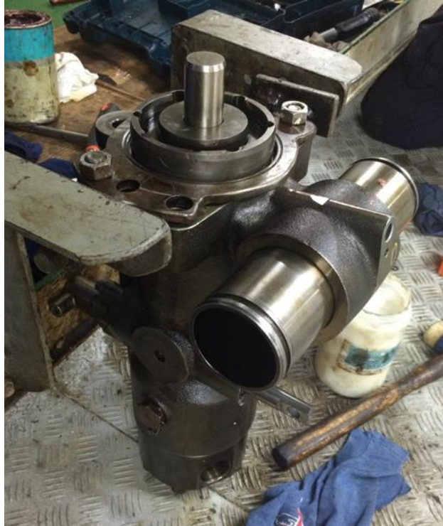
Ilustración 34: Bomba de inyección extraída
