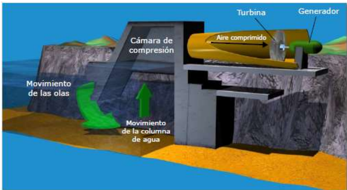
Fig 4. Instalación de columna oscilante de agua (OWC) (Fuente. www.eduambiental.org )
