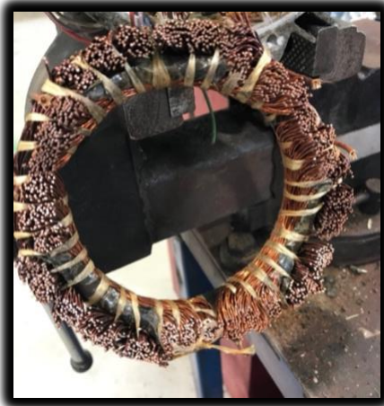
Ilustración 43: Corona cortada de uno de los lados del bobinado de la bomba sumergible
