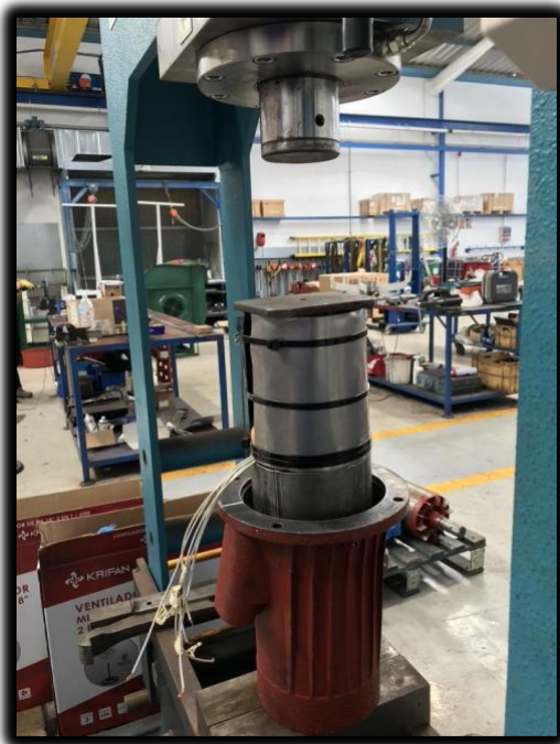
Ilustración 49: Montaje del estator en la carcasa
