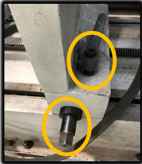
Ilustración 57: Palanca desbloqueo y) y tornillo sinfín regulador de ancho del punto de apoyo (Foto en primer plano)
