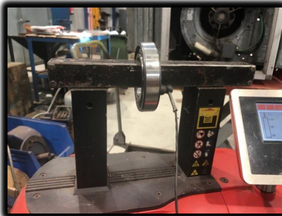
Ilustración 74: Montaje de rodamientos y demás accesorios del eje.
