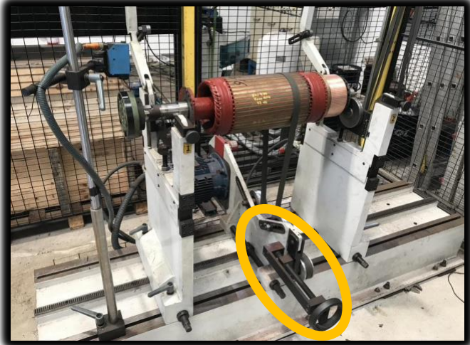
Ilustración 61: Volante regulador de tensión de la correa
