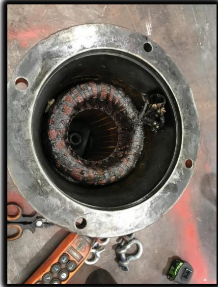
Ilustración 37,38: Estator y carcasa de una bomba sumergible
