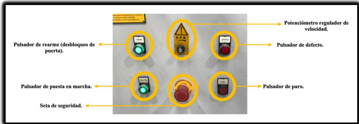
Ilustración 63: Panel de mando de la máquina equilibradora
