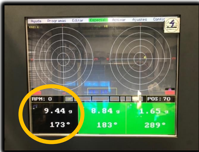
Ilustración 69: Cantidad de gramos que hay que añadir para el equilibrado del rotor
