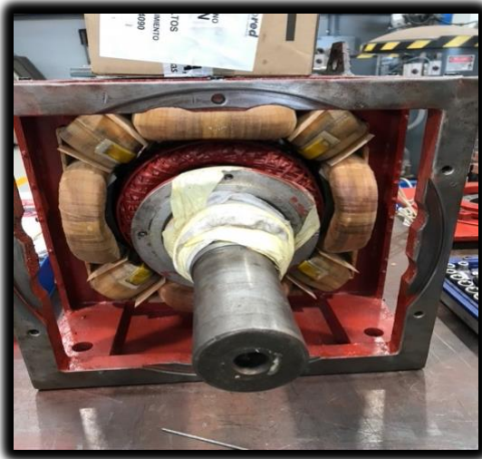
Ilustración 73: Montaje rotor en motor
