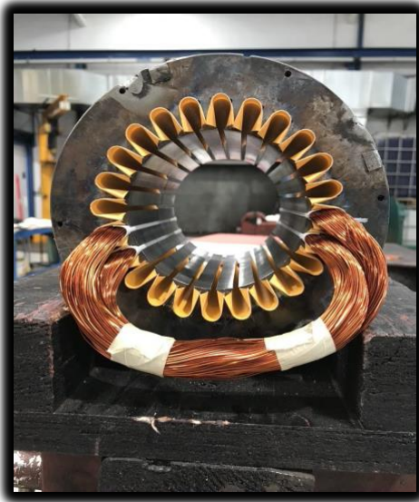
Ilustración 47: Colocación de las nuevas bobinas en el estator
