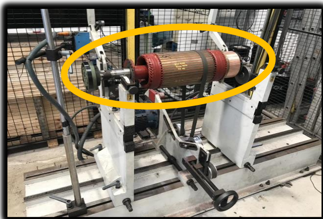
Ilustración 58: Montaje del rotor en la máquina equilibradora
