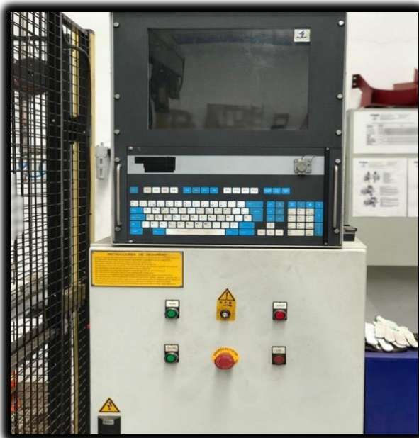
Ilustración 62: Panel de mando de la máquina equilibradora
