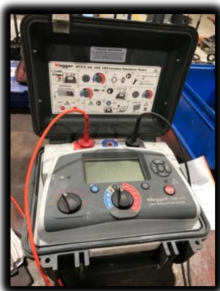
Ilustración 76: Prueba de Megado
