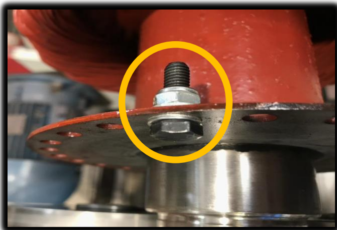
Ilustración 71: Material añadido para lograr el equilibrio
