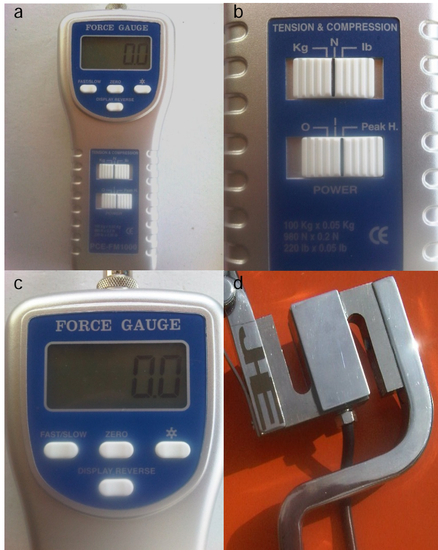
Figura 1.4 (a-d). Detalle de la galga PCE-FM 1000, incluyendo display y vista post producción de la galga adaptada al distractor.
