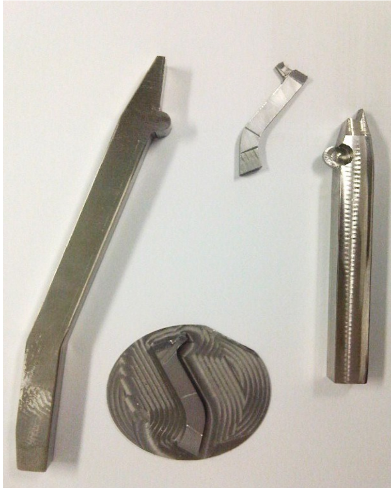
Figura 1.17. Despiece inicial de la pinza durante el proceso de fabricación.
