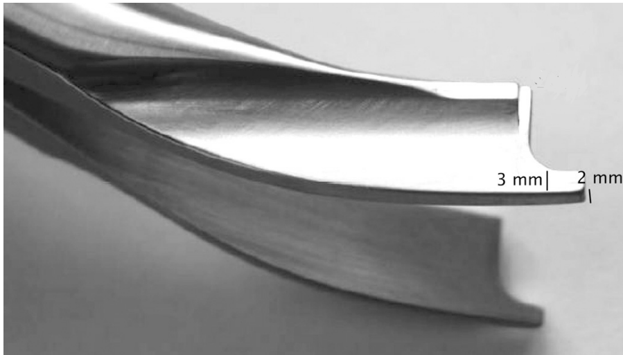
Figura 1.32. Detalle del extremo del distractor, en el que vemos como el extremo del mismo, no específicamente diseñado, no cumple con los requisitos de diseño previamente marcados en nuestro estudio.
