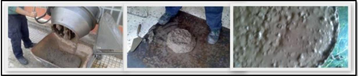
*Fig. 7.16. Proceso de amasado y cono de Abrams.*
