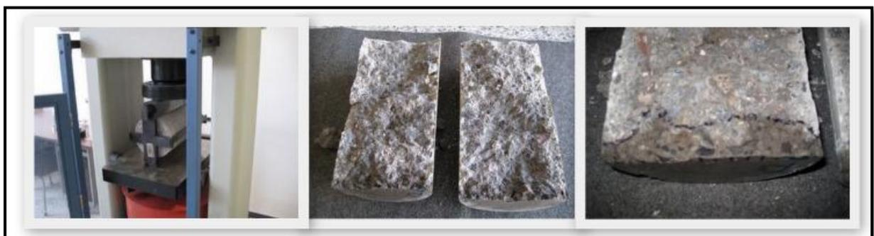
*Fig. 7.12. Ensayo de penetración de agua y rotura a tracción indirecta de la probeta 3b.*
