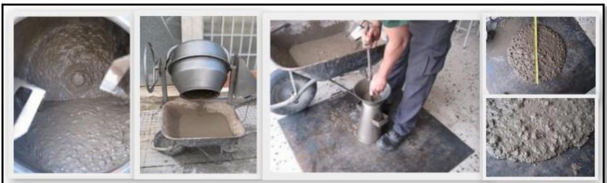
*Fig. 7.2. Proceso de amasado, cono de Abrams y medida del escurrimiento.*
