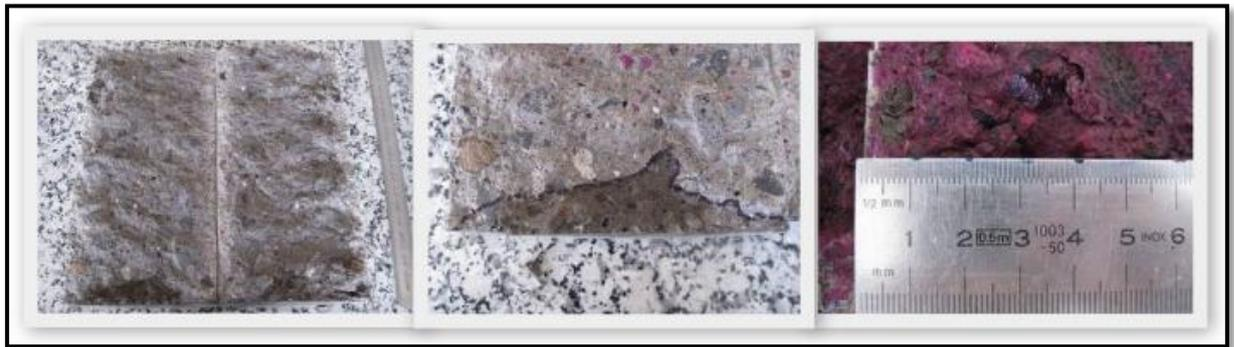
*Fig. 7.8. Rotura a tracción indirecta, ensayo de penetración de agua y medida de la carbonatación de la probeta 2b.*
