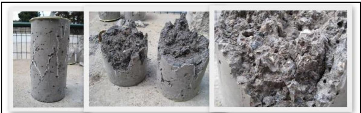
*Fig. 7.14. Rotura a compresión de la probeta 42a.*
