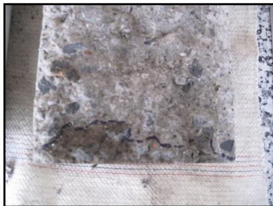
*Fig. 4.24. Ejemplo de frente de penetración.*
