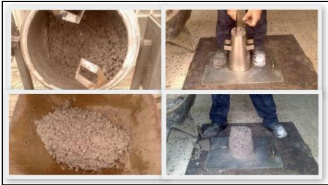
*Fig. 7.22. Proceso de amasado y cono de Abrams.*
