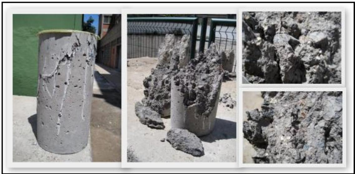
*Fig. 7.20. Rotura a compresión de la probeta 6a.*
