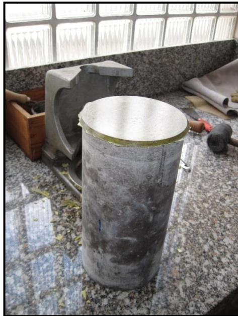
*Fig. 4.18. Probeta refrentada.*
