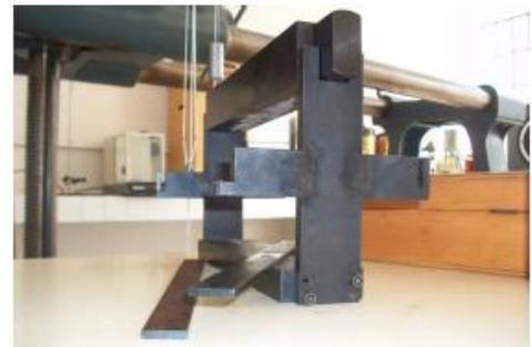
*Fig. 4.26. Dispositivo de ensayo para probetas cilíndricas (UNE-EN 12390-6<sup>[27]</sup>) Leyenda. 1: Pieza de acero de carga. 2: Bandas de apoyo*
