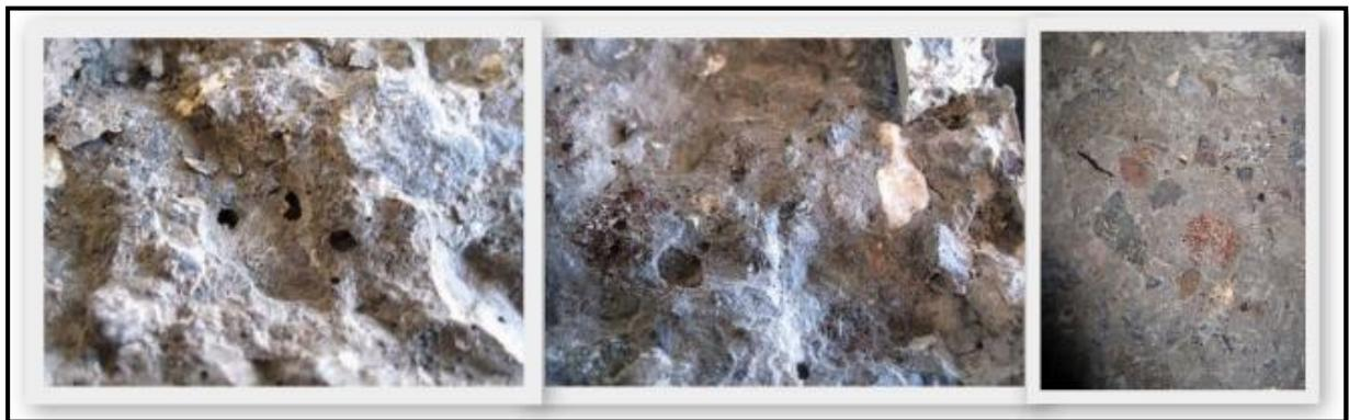
*Fig. 7.11. Detalle de la rotura de los áridos y coqueas en el interior de la probeta.*
