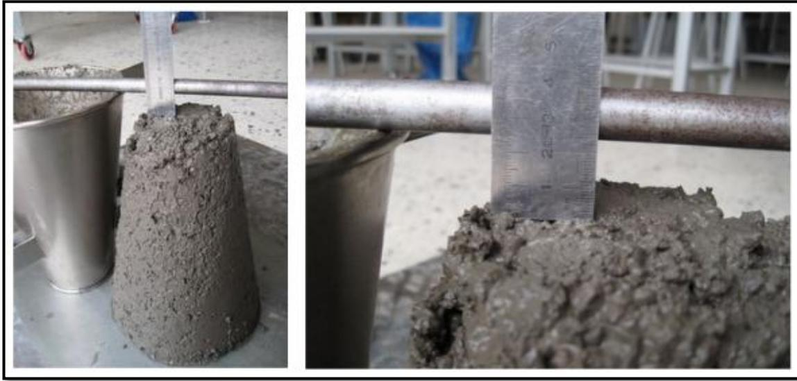
*Fig. 4.7. Ejemplo de medida de cono de Abrams.*
