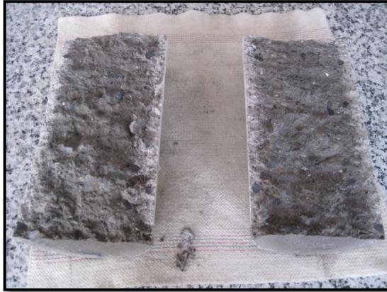
*Fig. 4.28. Ejemplo rotura a tracción indirecta.*
