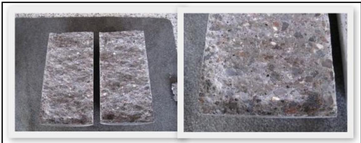
*Fig. 7.30. Ensayo de penetración de agua y rotura a tracción indirecta de la probeta 7b.*
