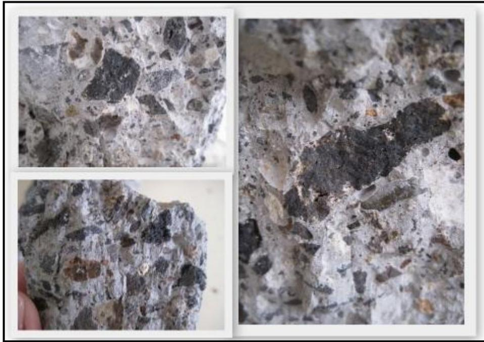
*Fig. 7.24. Detalle de la rotura de los áridos de la probeta 7a.*
