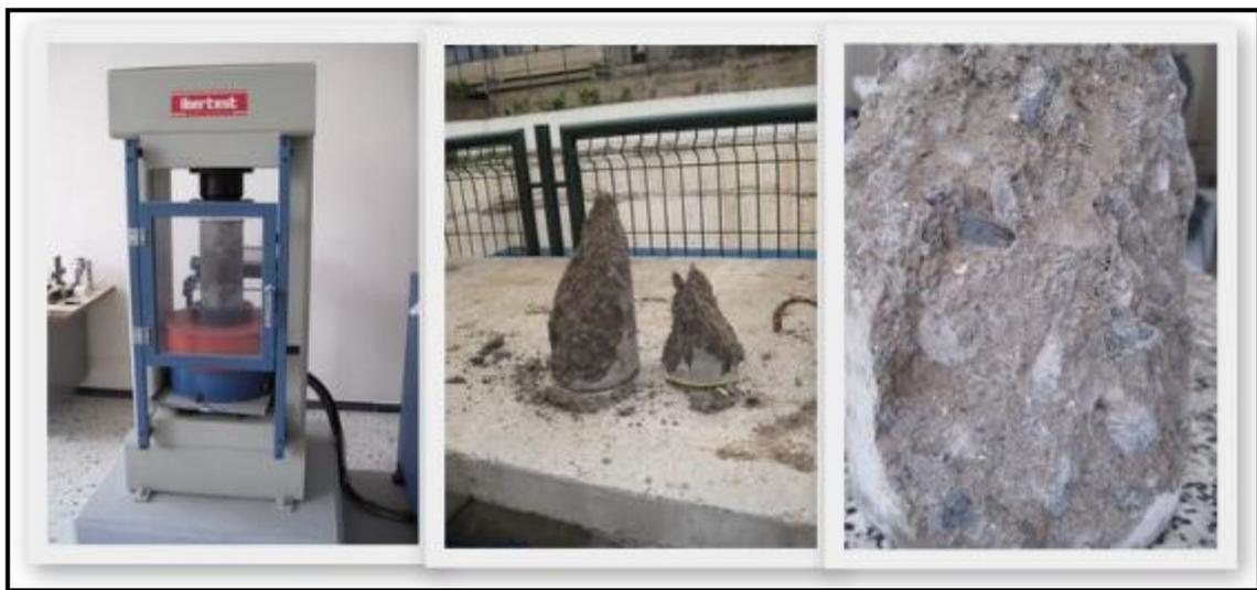
*Fig. 7.4. Rotura a compresión de la probeta 1a.*
