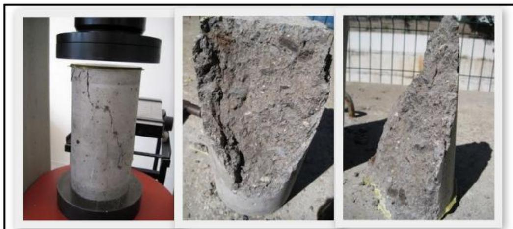
*Fig. 7.7. Rotura a compresión de la probeta 2a.*
