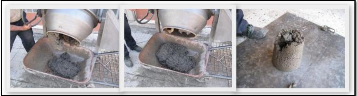
*Fig. 7.19. Proceso de amasado y cono de Abrams.*
