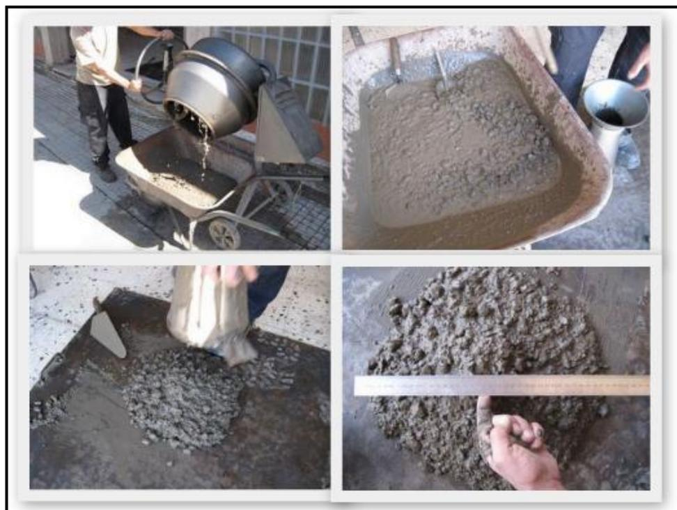
*Fig. 7.9. Proceso de amasado, cono de Abrams y medida del escurrimiento.*
