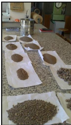
**Fig. 4.1.** Análisis granulométrico de los áridos.
