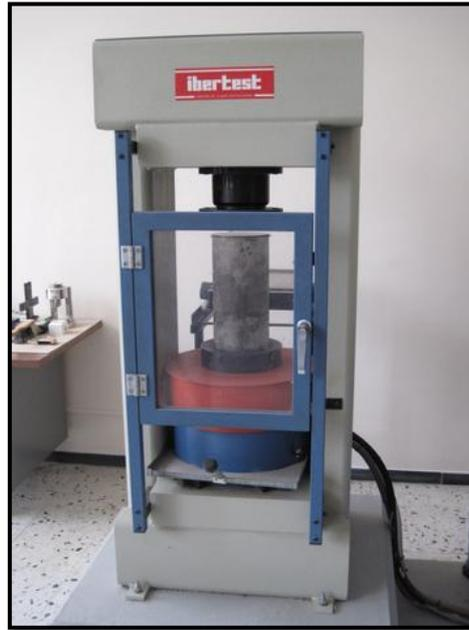
*Fig. 4.15. Máquina de ensayo a compresión.*
