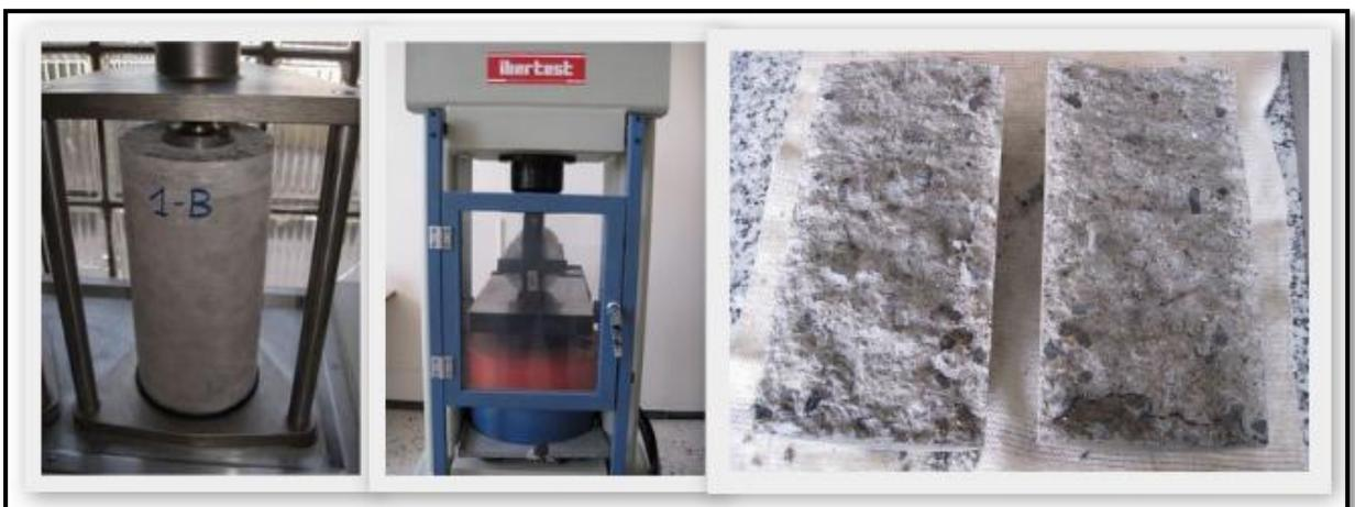
*Fig. 7.5. Ensayo de penetración de agua y rotura a tracción indirecta de la probeta 1b.*
