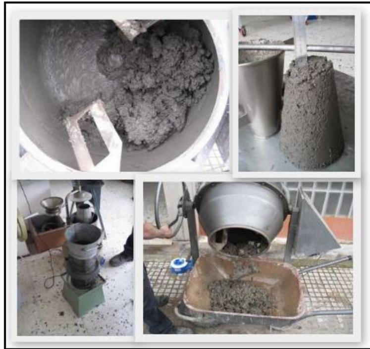
*Fig. 7.13. Proceso de amasado, cono de Abrams, y vibrado de la probeta.*
