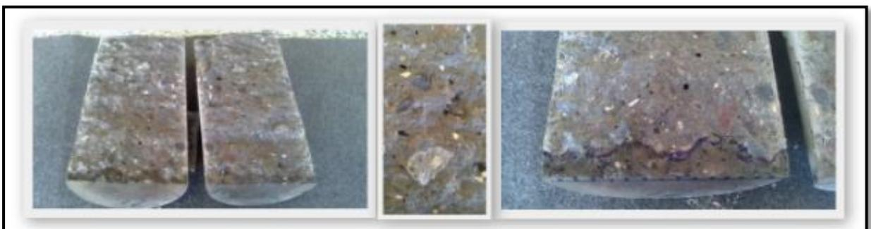
*Fig. 7.15. Ensayo de penetración de agua y rotura a tracción indirecta de la probeta 4b.*
