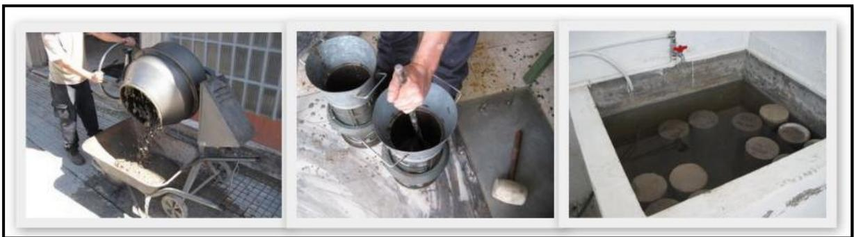
**Fig. 4.4.** Imagen del proceso de elaboración de las probetas.
