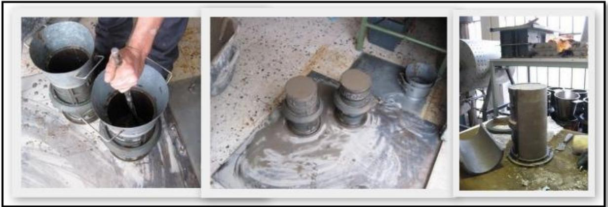
*Fig. 7.3. Confección y desmolde de las probetas.*
