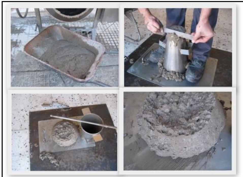
*Fig. 7.6. Proceso de amasado y obtención del cono de Abrams.*
