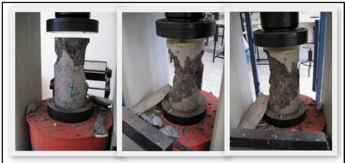
*Fig. 7.23. Rotura a compresión de la probeta 7a.*
