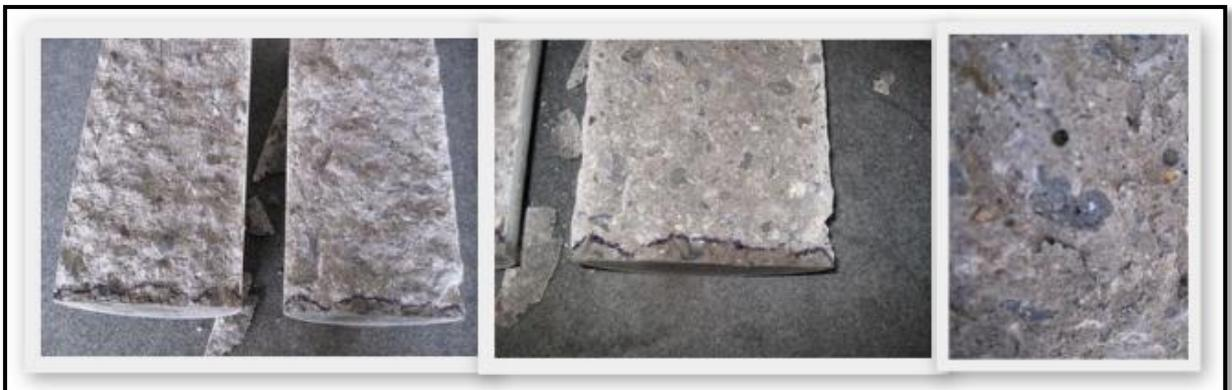
*Fig. 7.18. Ensayo de penetración de agua y rotura a tracción indirecta de la probeta 5b.*
