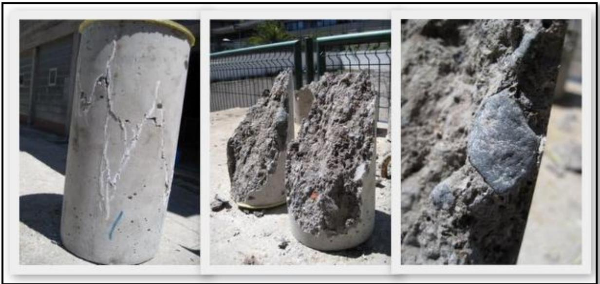
*Fig. 7.17. Rotura a compresión de la probeta 5a.*
