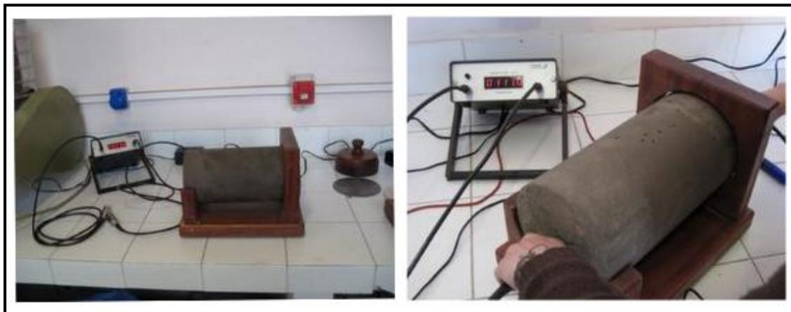
*Fig. 4.13. Equipo de medición de ultrasonidos.*
