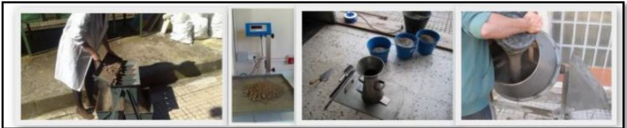
*Fig. 7.1. Proceso de obtención de materiales para el amasado del hormigón.*
