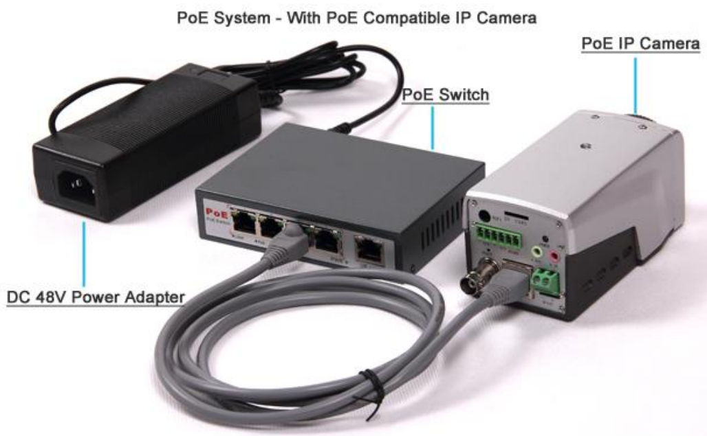
Figura 1.2.3. Cámara IP PoE y Switch PoE
