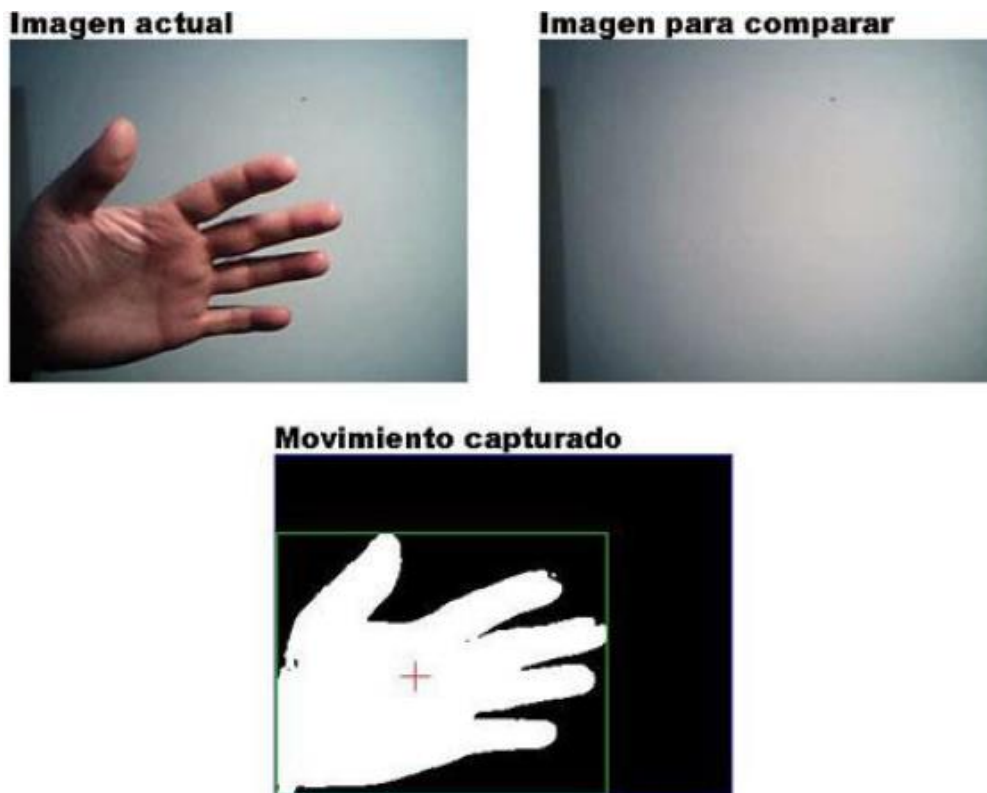
Figura 4.1.1. Detección de movimiento mediante substracción de vídeo
