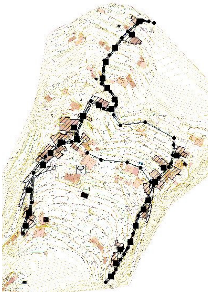
Figura IV.III Esquema utilizado en EPA-SWMM para la modelización de la red de pluviales.
