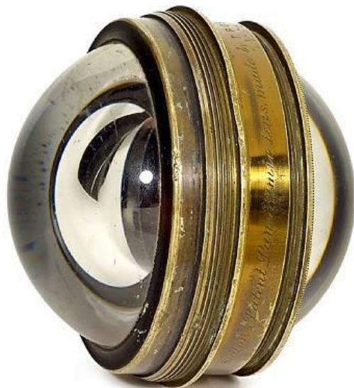
Lám. 5.21 Primera lente panorámica, patentada por Thomas Sutton en 1859. Logra 120 grados de ángulo visual gracias a su forma circular y su interior lleno de agua cristalina. Imagen: Inphoto (Conti, R.) (2015).
