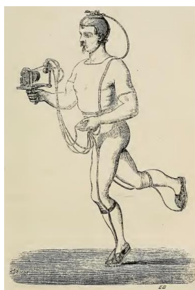
Lám. 3.12 Corredor equipado con dispositivos diseñados para registrar los diversos ritmos, ilustración de La machine animale: locomotion terrestre et aérienne (Marey, 1873, p. 131).
