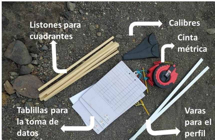
**Figura 6.** Materiales utilizados para el muestreo.
