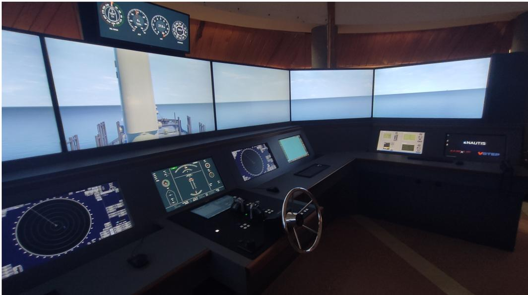
**Figura 2.4:** Simulador de navegación
