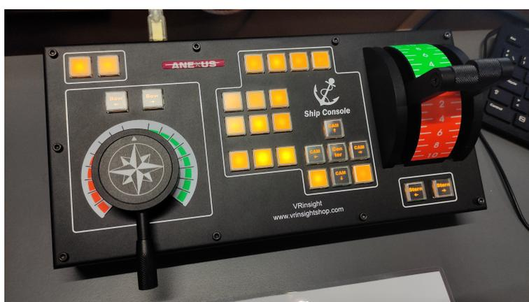
**Figura 3.2:** Consola de control en los puestos de simulación
