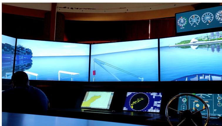
**Figura 3.1:** Simulador de navegación *Full bridge*
