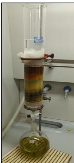
Figura 4.5. Columna cromatográfica
