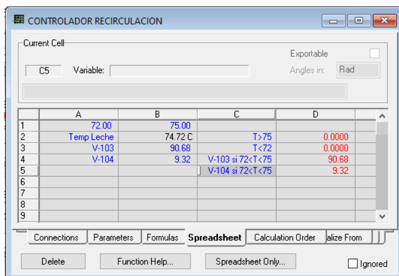
Imagen 29: Resultados en el “Spreadsheet” en un momento concreto. (VLV-103 abierta y VLV-104 cerrada).
