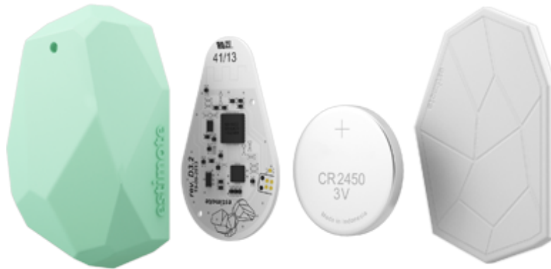
Figura 2.5: Interior de un beacon de Estimote
