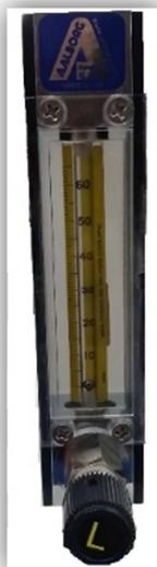
*Figura 5.5. Rotámetro utilizado.*
