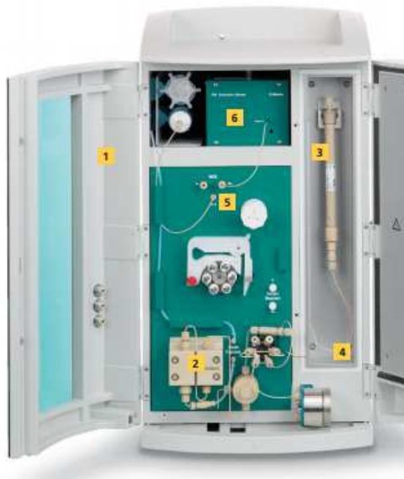
Figura 5.6. Partes más importantes del cromatógrafo iónico.
