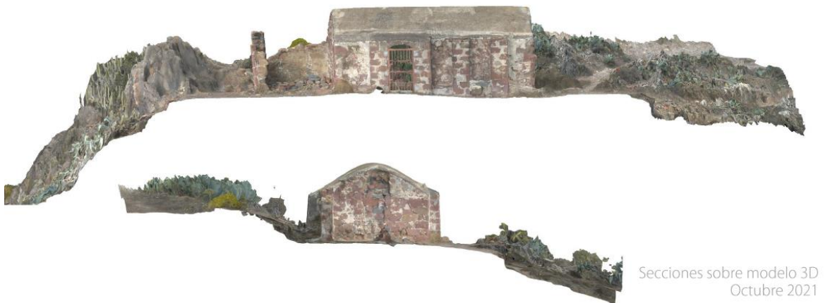
Figura 12. Ejemplo de documentación fotogramétrica con dron para la casa de la atalaya de Igueste de San Andrés.
