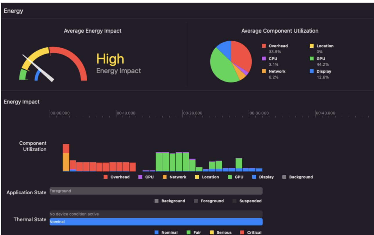
Figura 2.13: Impacto energético de la aplicación realizada en Ionic
