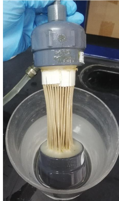
Imagen 2. Membrana después de limpieza.
