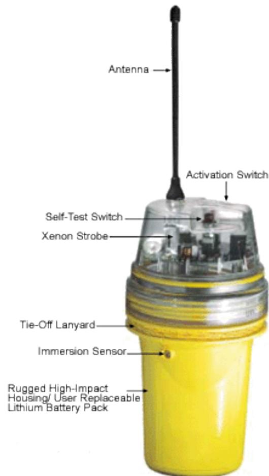
Ilustración 1.5. Partes de una radiobaliza EPIRB.
