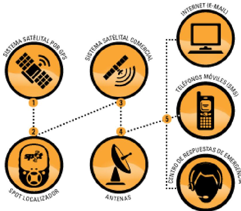
Ilustración 1.9. Funcionamiento de un SPOT.
