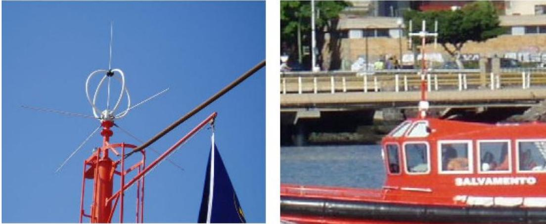
Ilustración 2.9. Distintos tipos de antenas de radiogoniómetros.
