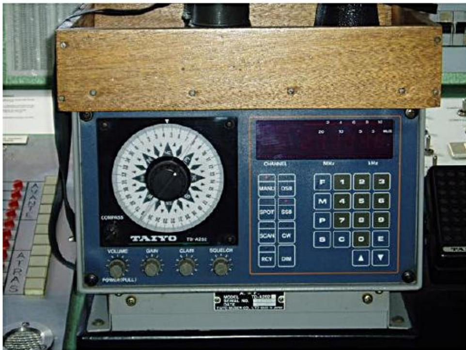
Ilustración 2.28. Receptor de HF.
