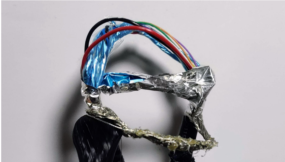
Figura 4.5: Cable USB-Type C sin apantallamiento
