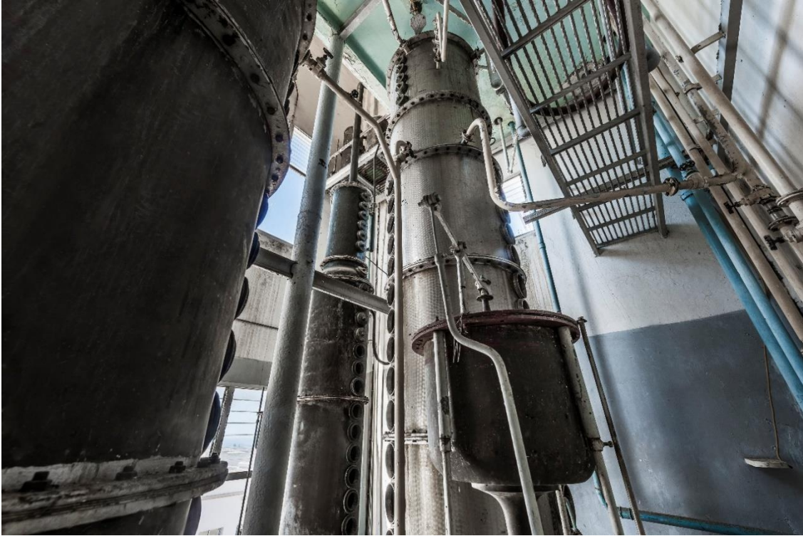
Ilustración 40. Columna de destilación y regulador de vapor. (Fondo documental Destilería de San Bartolomé de Tejina, S.A.).
