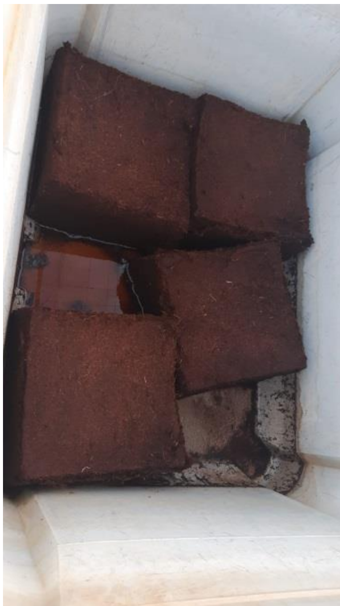
Figura 5. Hidratación de la fibra de coco. Fuente: Imagen tomada durante el ensayo, 2022.
