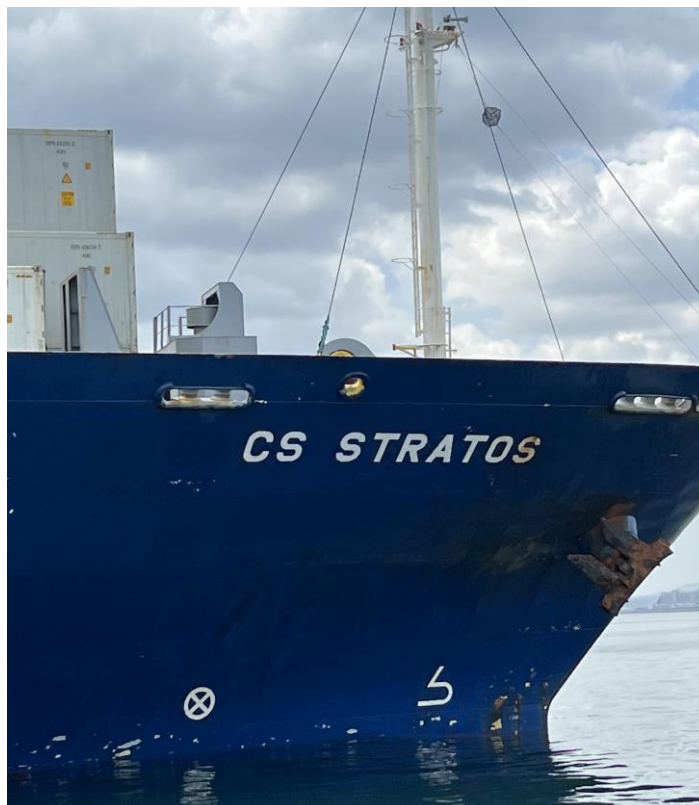
Ilustración 35. Buque "CS Stratos" fondeando con la marca de día – Fuente: Trabajo de campo.
