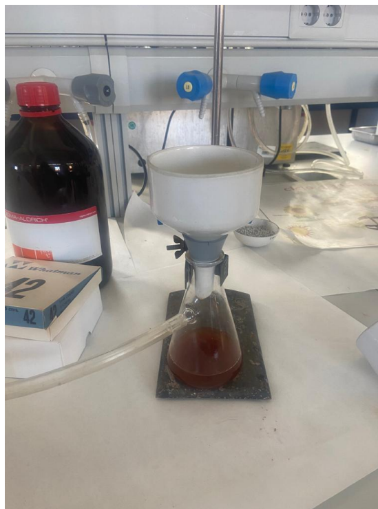
Figura 19. Sistema de filtración a vacío
