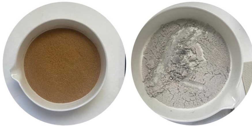
Figura 23. Las cascarás pulverizadas y el adsorbente obtenido después del proceso de calcinación
