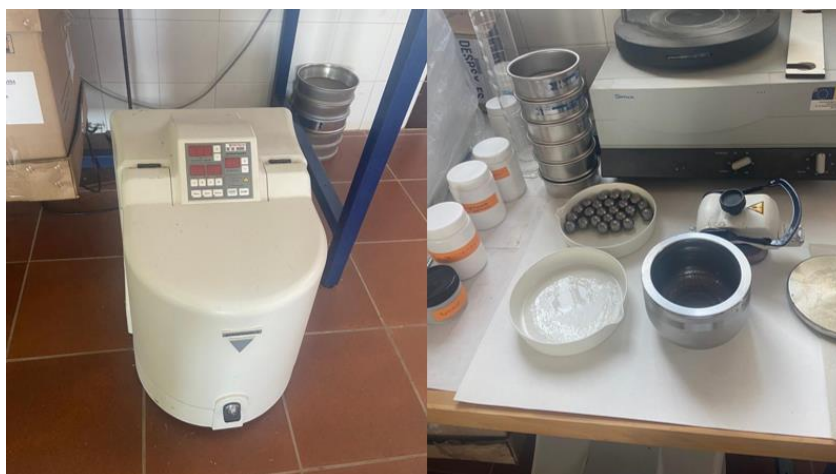
Figura 22. Equipo empleado para el proceso de pulverización (molino de bolas)
