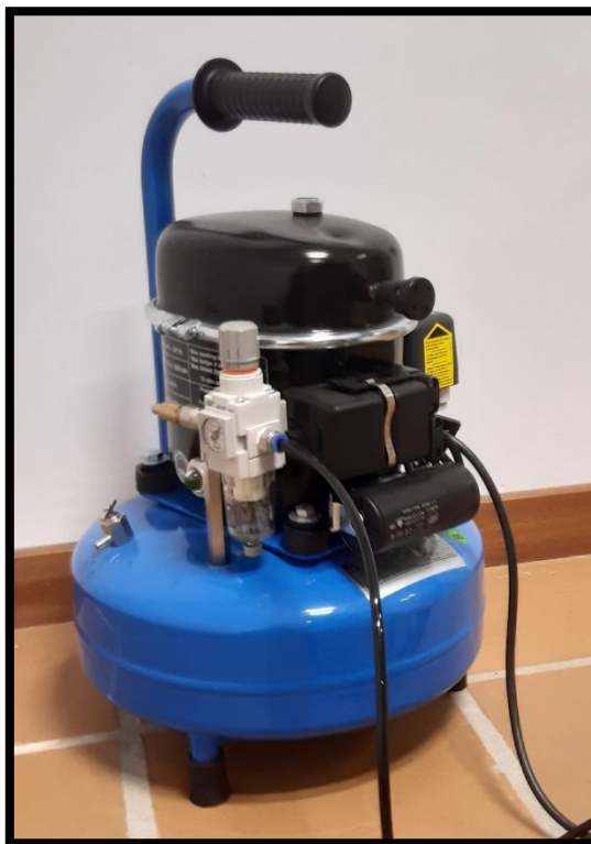
Figura 5.10: Compresor de la estación FAS-200.
