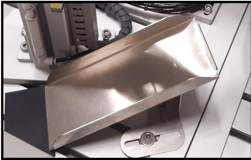
Figura 6.5: Rampa de evacuación para piezas rechazadas.
