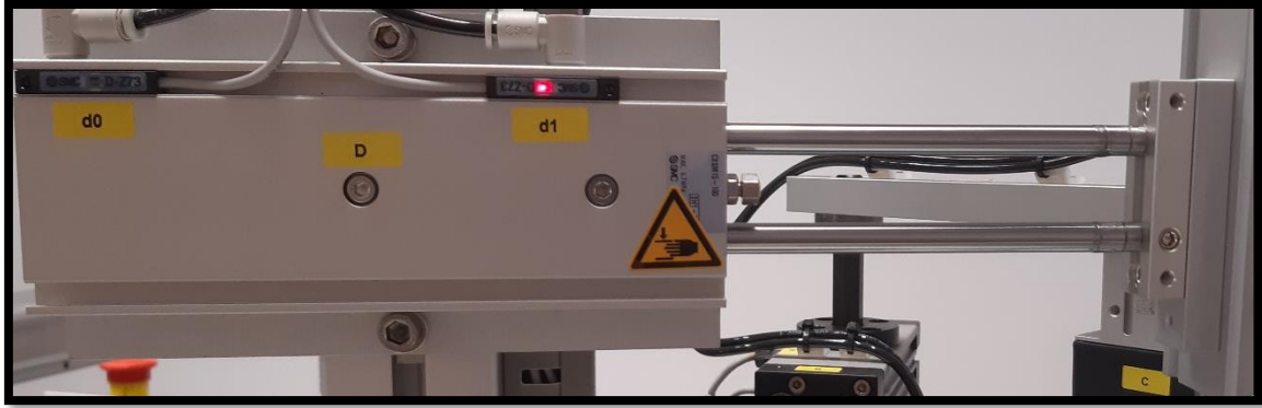
Figura 6.6: Cilindro de vástagos paralelos de doble efecto horizontal.
