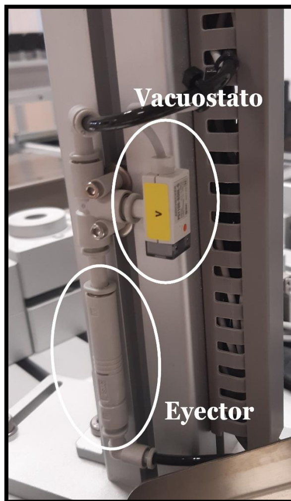
Figura 6.9: Vacuostato y Eyector del módulo de rechazo de la FAS-210.
