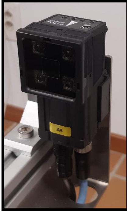
Figura 5.17: Cámara de la estación FAS-216.
