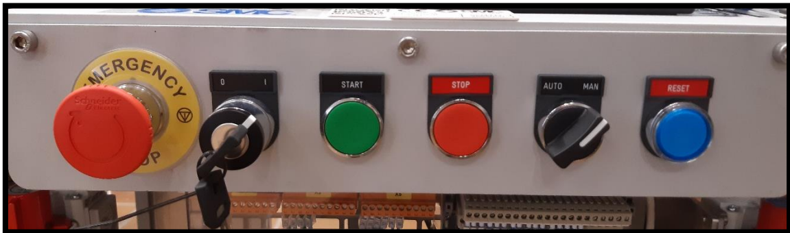
Figura 5.18: Botonera para las tres estaciones de la planta FAS-200.
