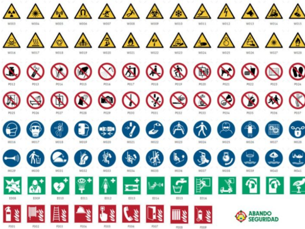
Figura 40: Señalizaciones de advertencia, prohibiciones y obligación.
